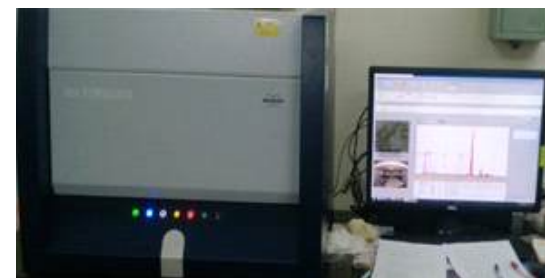
그림 1.2. 연세대학교 결정학연구실의 마이크로 X선 형광분석 장치
