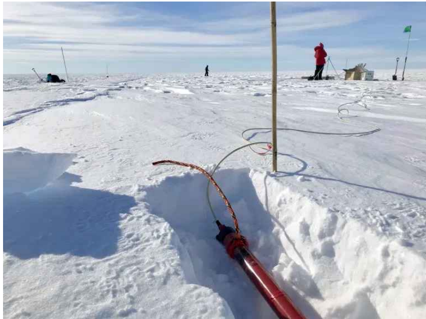
Fig. 52. 빙하 지하수 대상의 자기지전류 탐사 모습.
