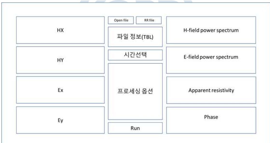
Fig. 46. MT 모니터링 자료처리 소프트웨어 GUI 구성 설계도.
