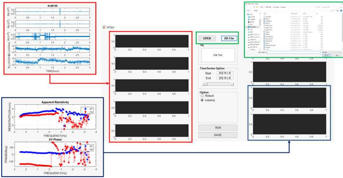
Fig. 47. MT 모니터링 자료처리 소프트웨어 GUI 제작 구성.
