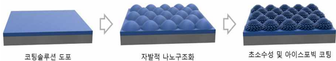
그림 2. 본 과제의 독창성: 자발적 나노구조화를 통한 초소수성 및 아이스포빅 코팅
