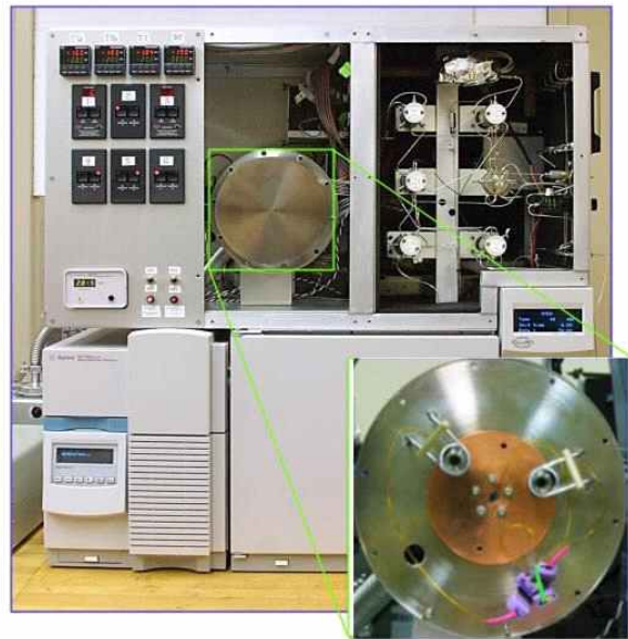
그림 13. 극저온 시료 흡착 기술을 활용한 대기 중 극미량 CFCs 분석기기
