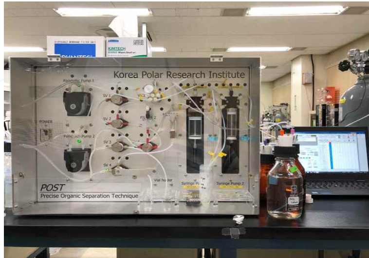
그림 38. 전자동 용존 유기물 추출 장치 (Precise Organic Separation Technique: POST)
