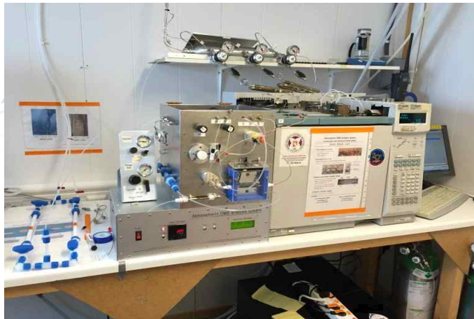
그림 8. 북극 제플린 관측기지에 설치된 gas chromatography 대기 DMS 연속 관측 시스템
