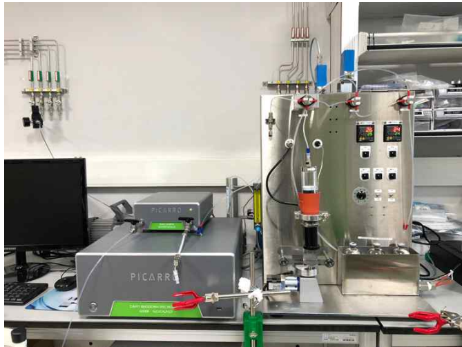
그림 24. 신규 용존 가스추출 장치 (좌) 및 Cavity Ring Down Spectroscopy
