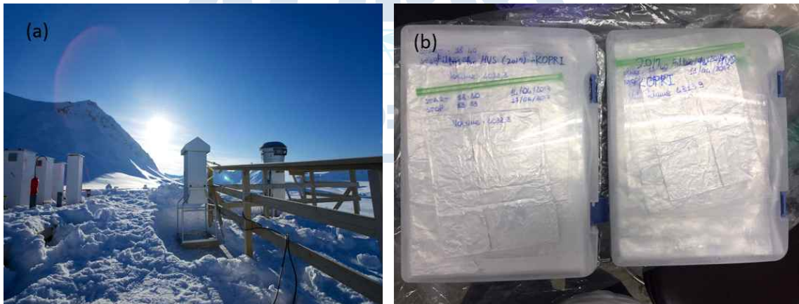
그림 40. (a) 북극 다산기지 인근 그루바뱃 관측기지 옥상에 설치된 High volume sampler (HVS) (b) HVS를 통해 획득한 PM 2.5 (직경 2.5 \mu m 이하 대기입자) 시료
