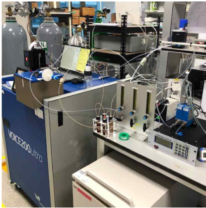
그림 33. 이온선택형 질량분석기 및 용존가스 연속 추출 장치
