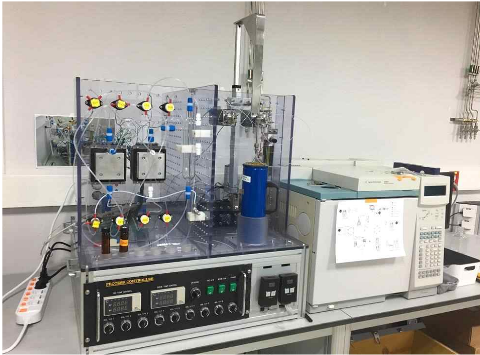
그림 18. 저농도 용존 가스 추출을 위한 purge and trap 전처리 장치
