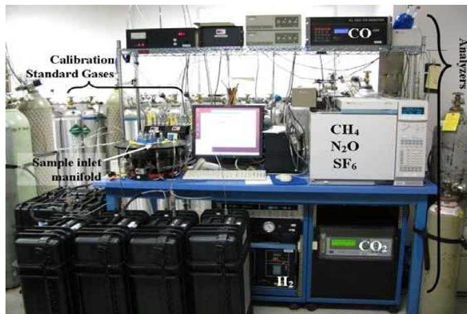
그림 12. 미국 ESRL에서 개발한 사용 중인 온실 가스 분석 시스템
