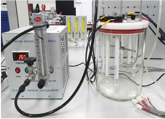
그림 58. 일차 해양 미세입자 모사 실험을 위한 Polar Marine Aerosol Simulation Chamber (PMAS) 시스템
