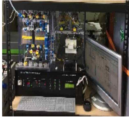
그림 82. 세종과학기지 대기빙하관측동에 설치한 대기 DMS 분석용 전처리 장치 (최초 설치일자: 2017년 12월, 시스템 보완 및 재설치 일자: 2018년 12월)
