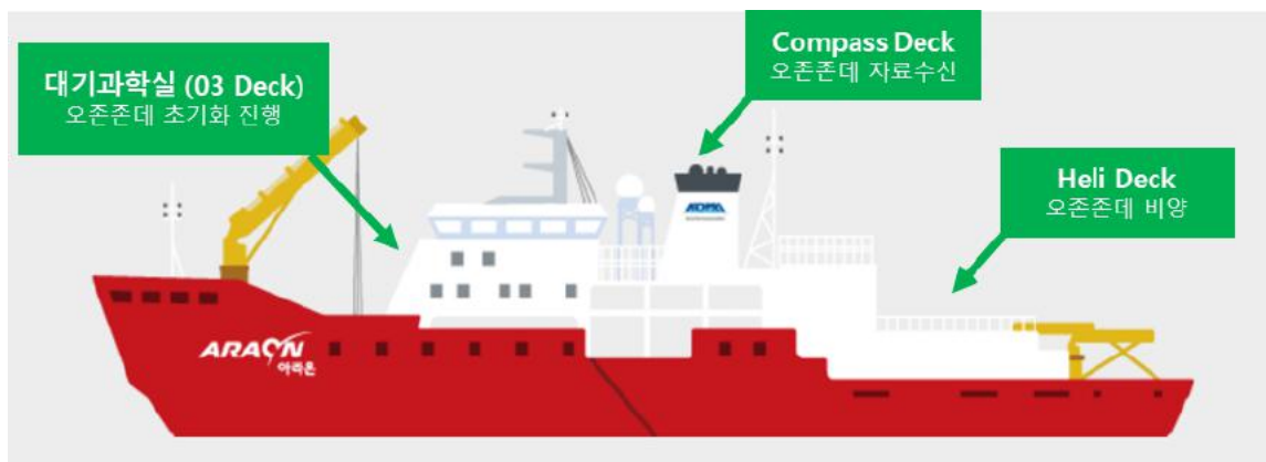
그림 3-1. 북반구 오존감시를 위해 설치된 오존존데 장비 설치 및 비양 위치 모식도
