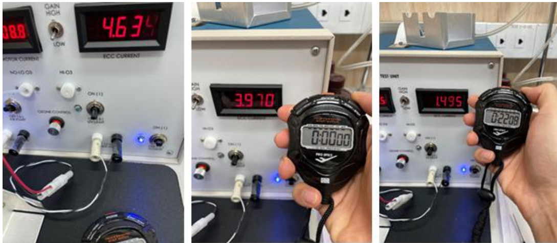
그림 3-13. 오존존데의 센서 반응 속도 측정 예시
