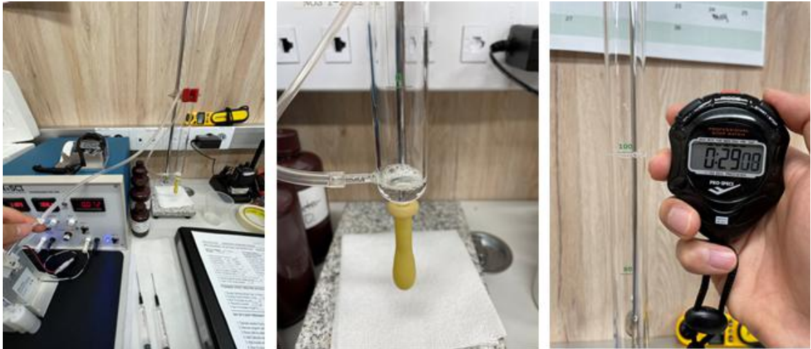
그림 3-15. 오존존데의 펌프 유량 측정 예시
