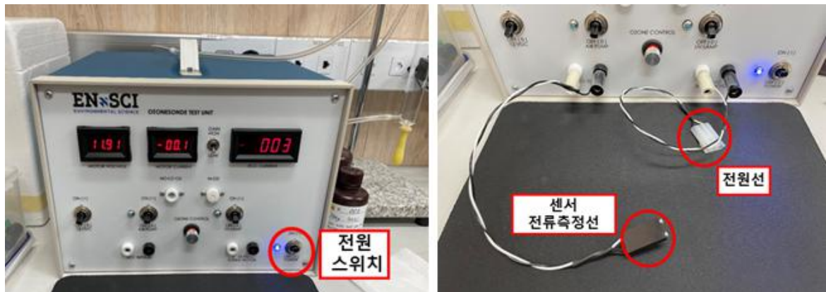
그림 3-7. (왼쪽) 전원을 켜 준 상태의 오존테스트 유닛과 (오른쪽) 전원선 및 센서 전류측정선을 연결 예시
