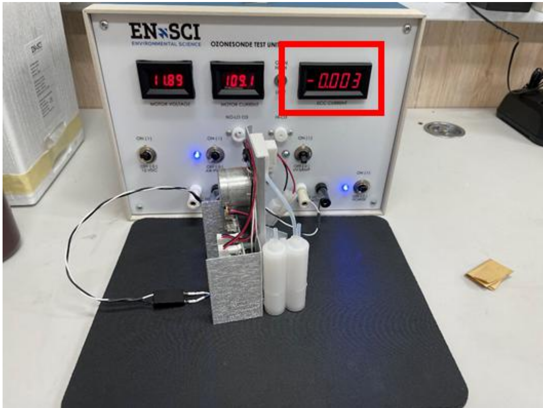
그림 3-11. 오존테스트 유닛의 오존존데 배경전류 측정 예시
