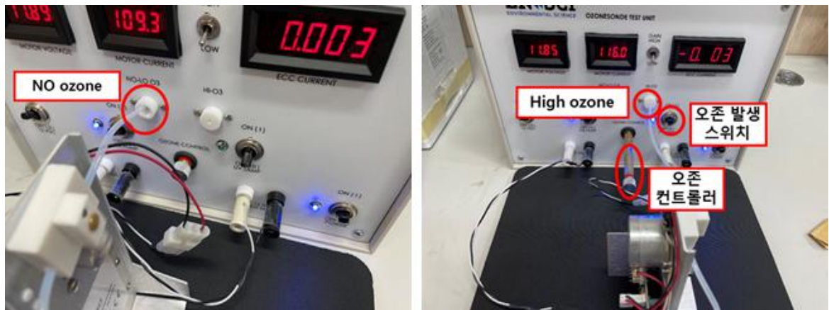
그림 3-9. 오존테스트 유닛의 오존 발생 스위치 및 오존 컨트롤러 작동 예시
