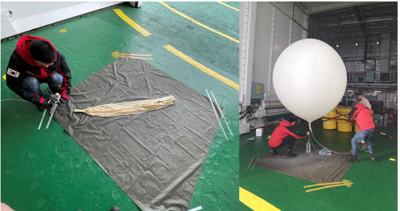
그림 3-6. 존데 비양을 위해 준비중인 헬륨 주입 과정. 안정적인 비양 준비를 위해 바람의 영향이 적은 헬리 덱에서 진행함
