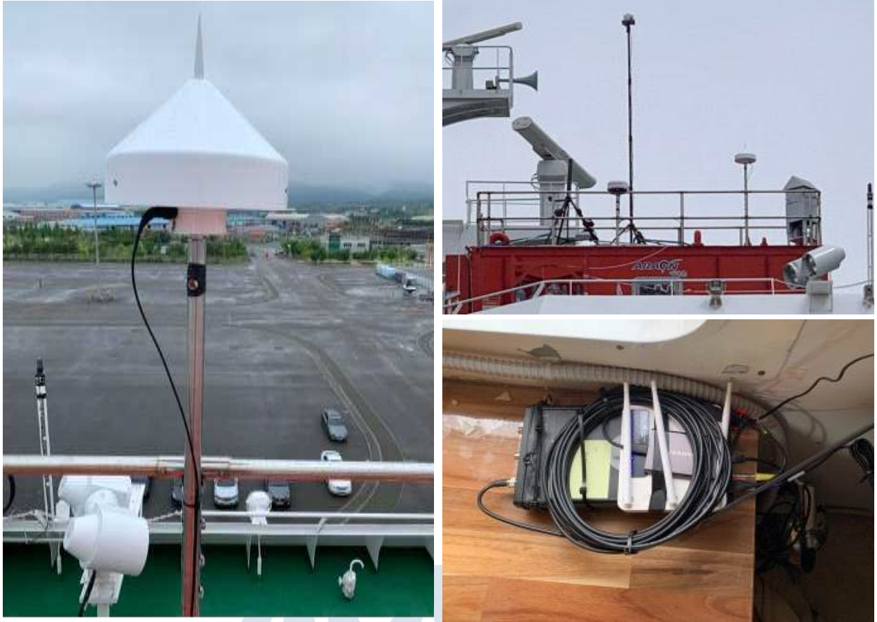
[아래온 쇄빙선 GPS 전리권 신틸레이션 관측기 설치 모습]
