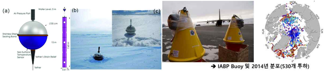
그림 3-1-3. IABP 모식도 및 현장 설치된 모습 및 투하 해역.
