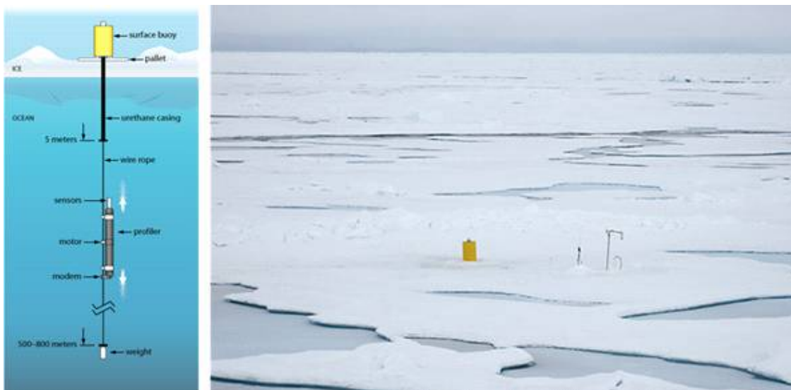
그림 3-1-1. ITP의 모식도와 현장에 설치된 모습 ( http://www.whoi.edu/page.do?pid=20756 ).
