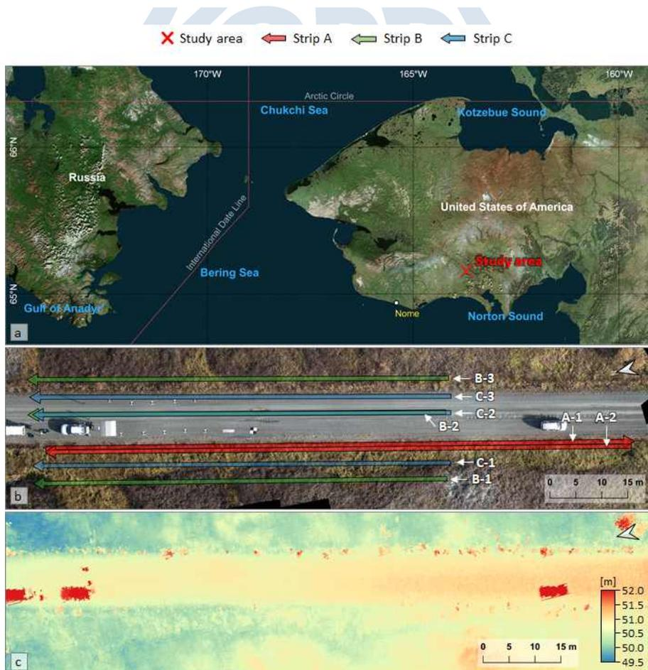
그림 3-2-5. 실험자료 취득 개요: (a) 연구지역, (b) 초분광 스트립 취득을 위한 비행경로, (c) 처리된 LiDAR DSM.
