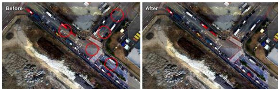
그림 3-2-9. Boresight calibration에 따른 초분광 센서자료의 기하보정 결과 비교
