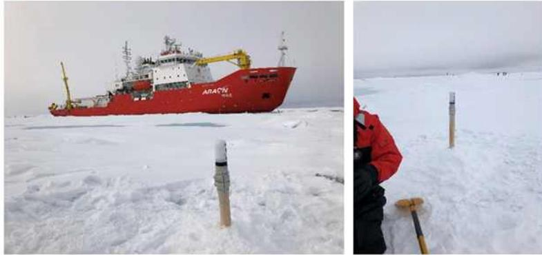
그림 3-3-6. 북극해 해빙에 이동 추적을 위한 트래커 설치 모습
