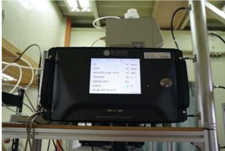
Fig. 3.4.13. 세종과학기지 대기 관측동에 설치된 Aethelometer (AE33)
