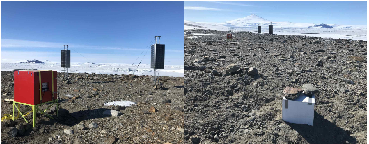
Fig. 19 (왼쪽) 장보고기지 무인 우주환경 관측소 초기 모델 설치로 Iridium을 활용한 장비 상태 감시와 지상 연구 장비의 안정적인 전원 공급 성능 시험 수행. (오른쪽) 지상에서의 지구 자기장 세기 측정을 위해 설치한 fluxgate 자력계
