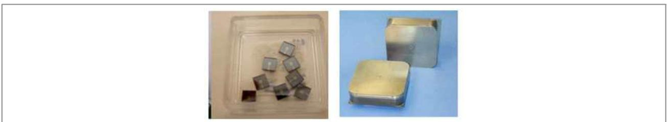
[그림 5-20] 초소형위성의 추력기 (좌) Cold gas (우) 전기추력기(FEEP)
