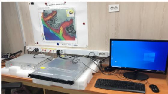
그림 43. 아라온 드라이랩에 새롭게 설치한 소노부이 기록 시스템
