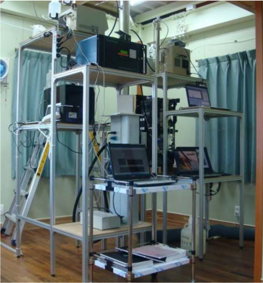
남극 세종과학기지 대기 관측실에 설치되어 있는 극초미세먼지와 구름응결핵 실시간 관측 장비들
