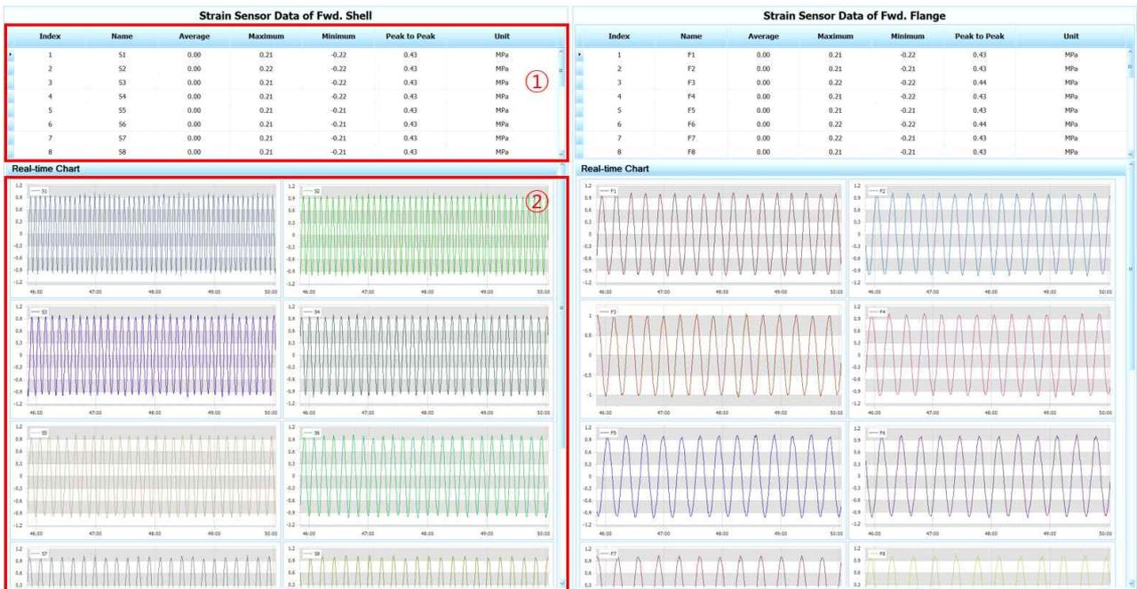
✓ 메인화면에 표현한 strain gauge의 데이터를 자세하게 모니터링 할 수 있는 화면으로, 좌측에는 Shell에 부착된 센서, 우측에는 Flange에 부착된 센서의 데이터를 표현함.
