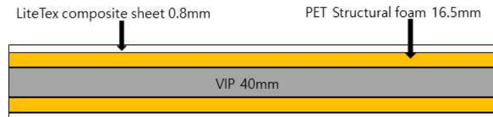
<그림 29> 개선된 스마트 고단열 컨테이너에 적용된 벽면구조
