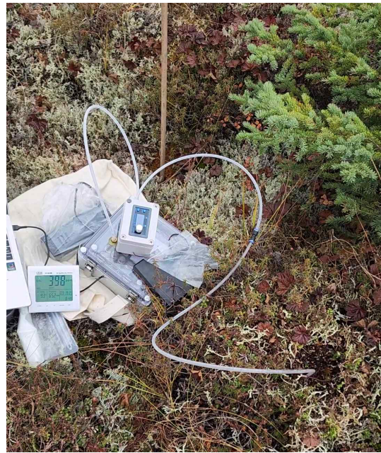
〈그림 3-54(f)〉 현지 test: 동토층의 깊이별 측정 테스트 사진
