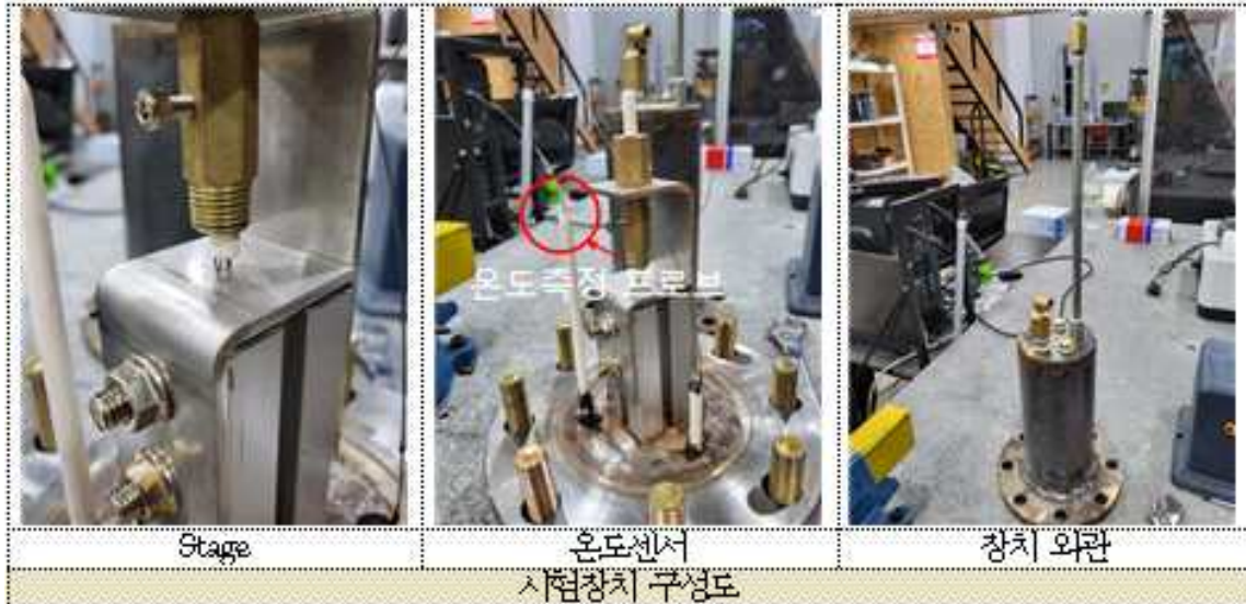
<그림 3-31(b)> 센서 시험 장치 설계 구성도: Stage, 온도센서, 장치 외관
