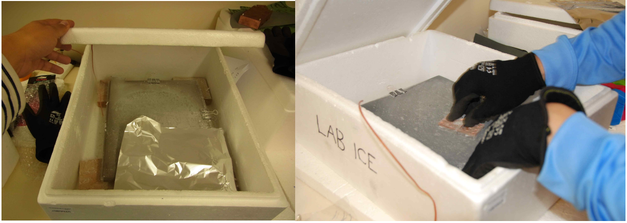
<스티로폼과 사포를 이용해 얼음연마장치를 설치하고, 얼음샘플을 연마하는 모습>
