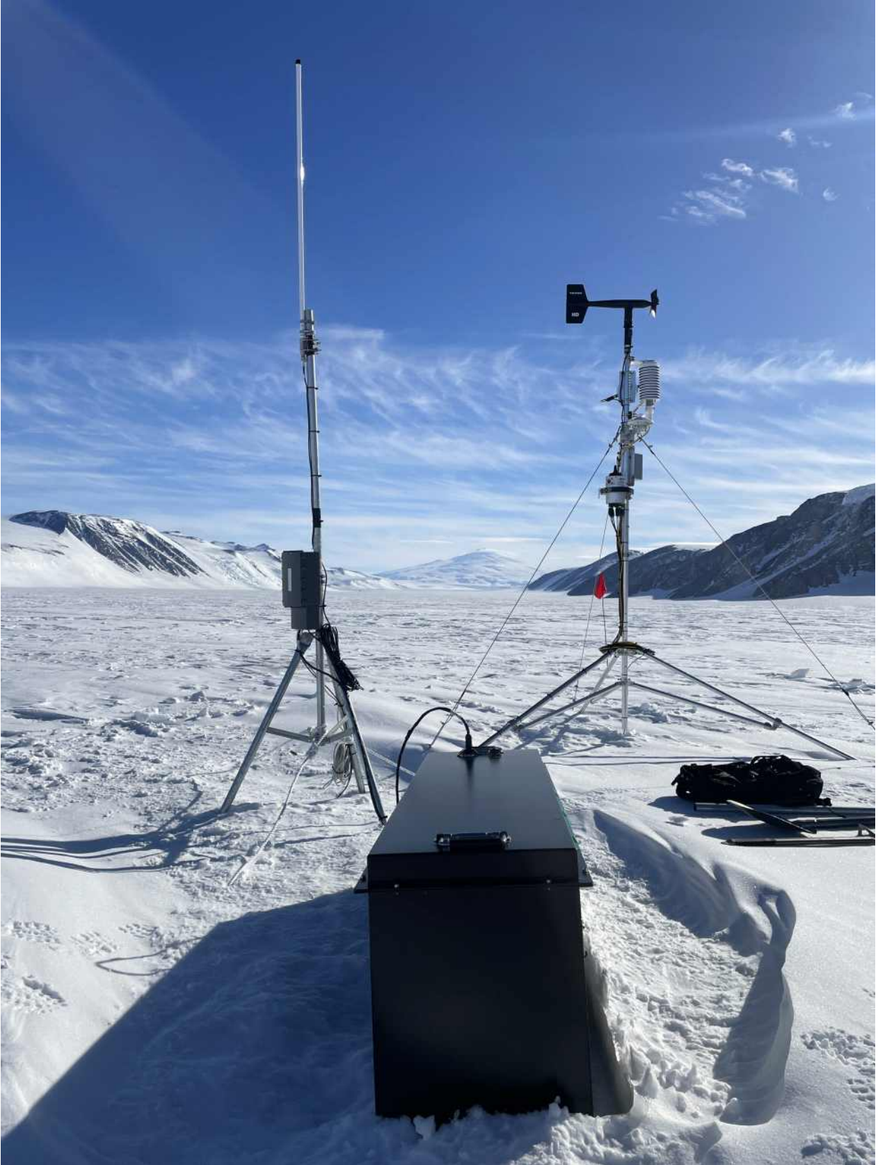
[사진6] 브라우닝 패스 관제 거점과 약 2km 떨어져 있는 관측소에 설치된 IoT 디바이스
