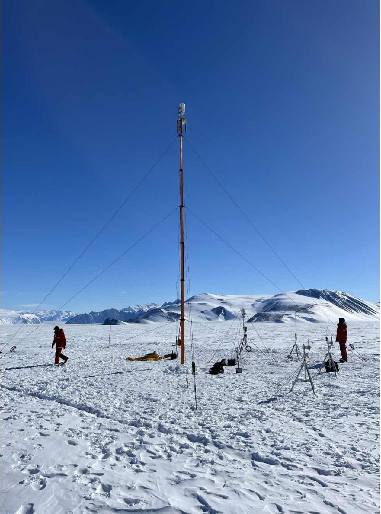
[사진5] 약 해발 2800m 마운트멜번 정상 관측소에 설치된 loET gateway 및 통신 장비
