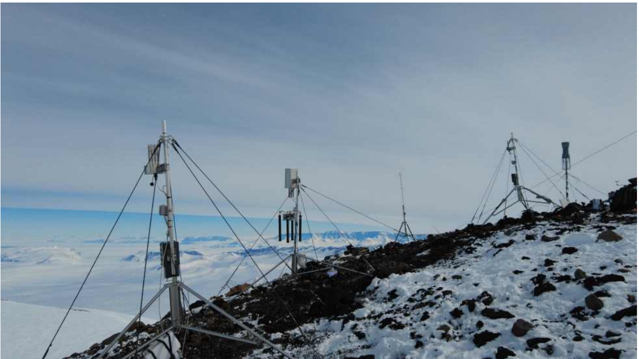
[사진2] 약 해발 2800m 마운트멜번 정상 관제거점에 설치된 IoT gateway 및 통신 장비
