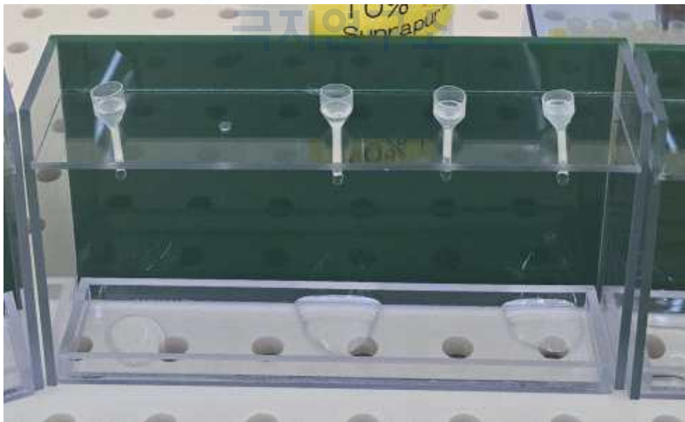
그림 3. 자체 제작 마이크로 컬럼과 음이온 교환 수지를 활용한 철 정제 시스템.
