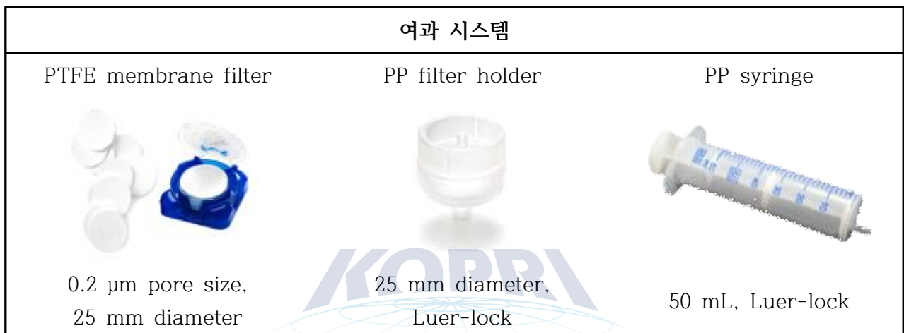
그림 2. 용해성 철과 비용해성 철 분리를 위한 여과 시스템.
