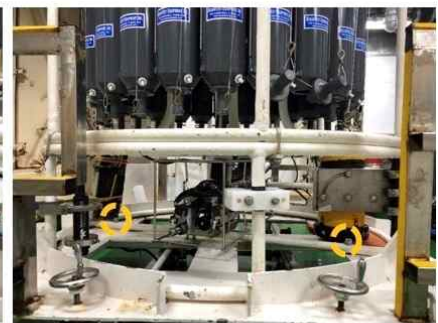
그림 8. 일반 채수시스템에서 사용되는 Niskin 채수기 내부에 장착된 고무밴드는 아연의 오염을 초래할 가능성이 높음. 납의 경우 일반채수시스템에 무게를 가하기 위해 부착되어 있으며 사진에서 붉은색 원으로 표시됨
