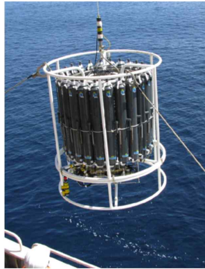
그림 2. GEOTRACES Program을 통해 활용되고 있는 청정해수시료 채수시스템의 예 (Sohrin and Bruland, 2011)
