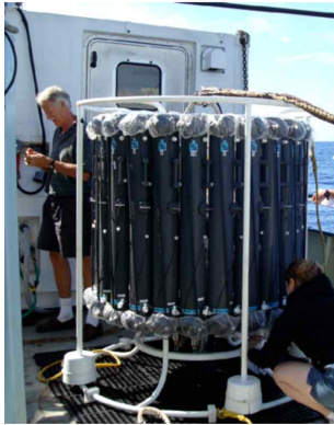
그림 2. GEOTRACES Program을 통해 활용되고 있는 청정해수시료 채수시스템의 예 (Sohrin and Bruland, 2011)
