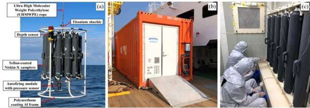
그림 4. 아라온호 시험항해시 구축된 청정해수시료 채수시스템. (a) 미량금속 분석용 채수시스템의 구축, (b) 아라온호 후부 갑판에 배치된 시료분취용 클린 컨테이너, (c) Niskin-X 채수기 거치가 가능하도록 개선된 클린컨테이너 내부에서 오염을 배제한 분석용 시료의 분취
