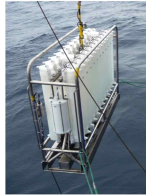
그림 2. GEOTRACES Program을 통해 활용되고 있는 청정해수시료 채수시스템의 예 (Sohrin and Bruland, 2011)
