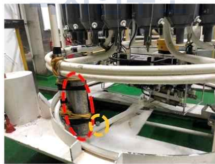
그림 8. 일반 채수시스템에서 사용되는 Niskin 채수기 내부에 장착된 고무밴드는 아연의 오염을 초래할 가능성이 높음. 납의 경우 일반채수시스템에 무게를 가하기 위해 부착되어 있으며 사진에서 붉은색 원으로 표시됨
