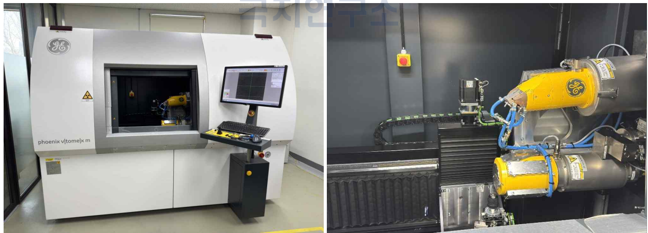
그림 7. Baker Hughes사 VtomeX M 240D(모델명) Nano CT scanner의 외관(좌) 및 내부 센서(우) 사진.
