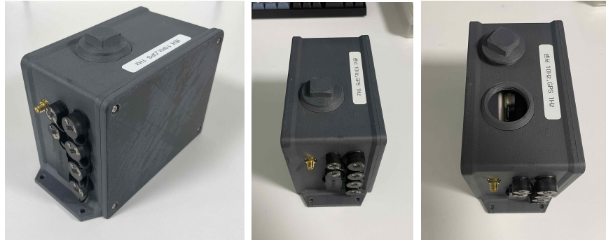
<그림 411. 데이터로거 개선 설계-SD탈착용 도어캡 적용>
