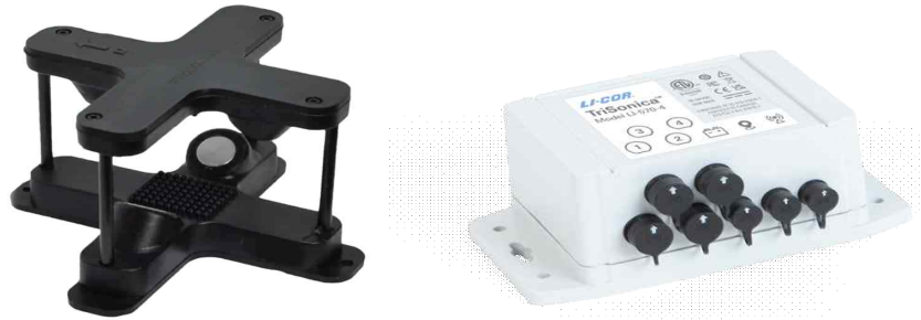
<그림 408. 센서 : Trisonica Mini, 데이터로거 : DL-422>
