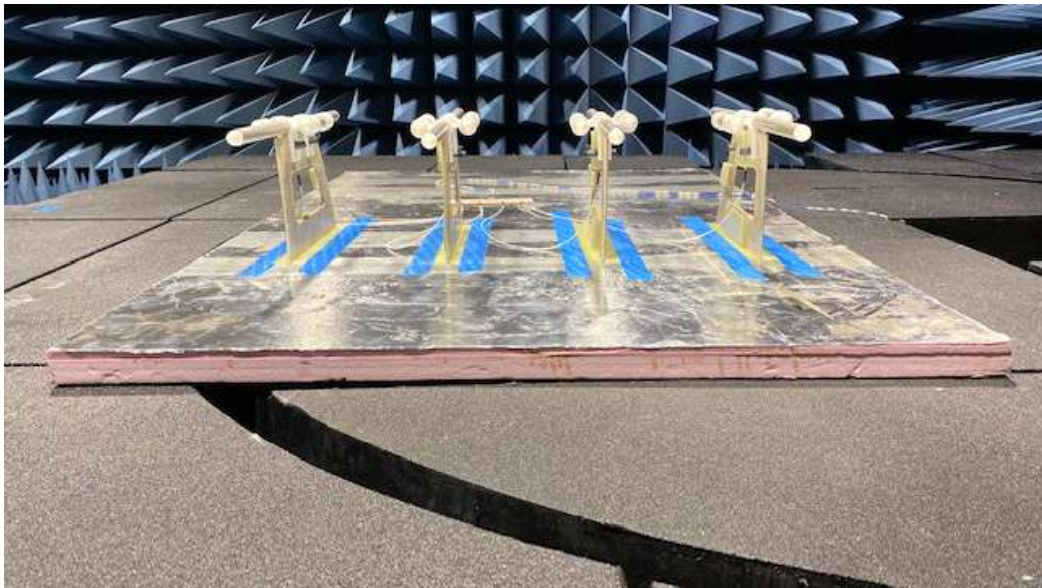
<그림 119. 4 element 안테나 어레이 프로토타입>
