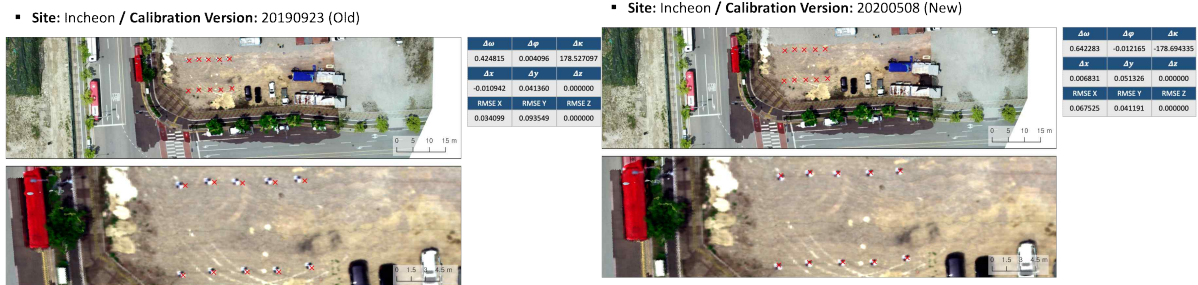
<그림 173. VNIR-SWIR 초분광 통합 시스템의 위치정확도 재보정 수행 전 (좌측)과 후 (우측) 결과 비교>
