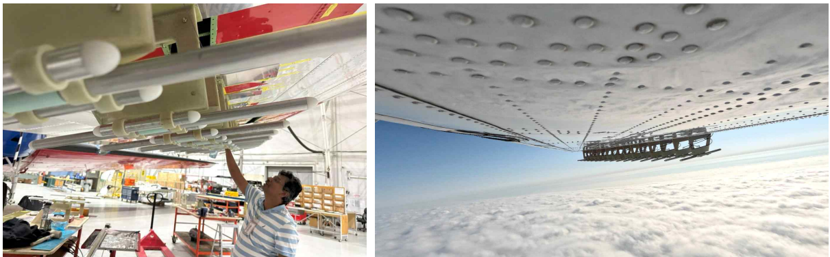
<그림 348. 항공기 날개에 장착된 안테나 어레이 점검(좌) 및 인증 비행시험 중 촬영된 안테나 레이(우)>
