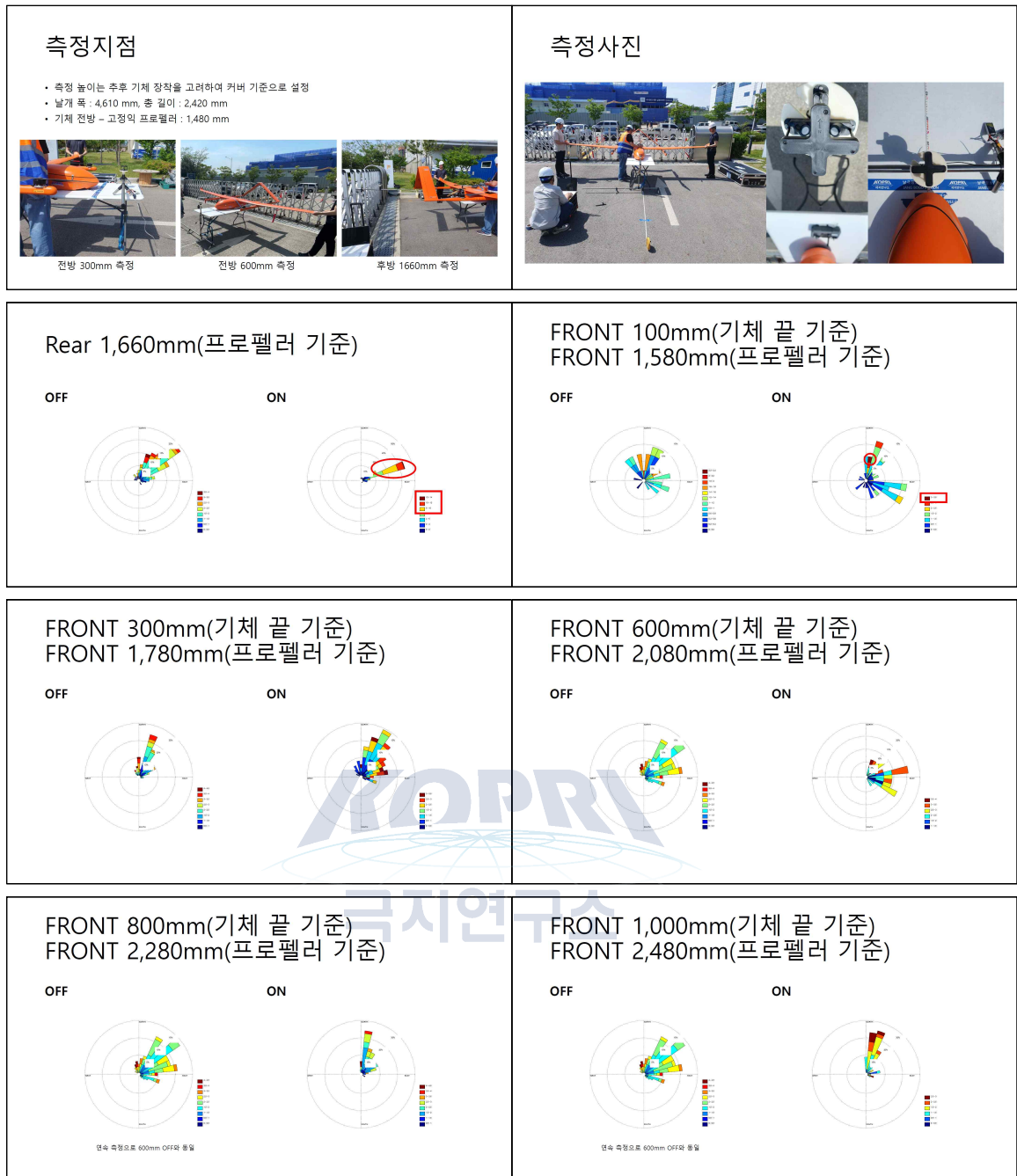
<그림 405. 기상관측 시스템 설계 변수(동체와 이격거리) 도출 실험 및 결과>
