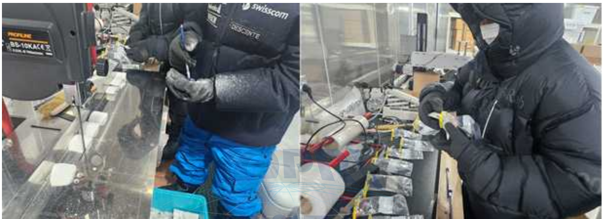
<그림 334. 남극내륙탐사 중 획득한 빙하코어 시료를 냉동실험실에서 1차 절삭하는 장면>
