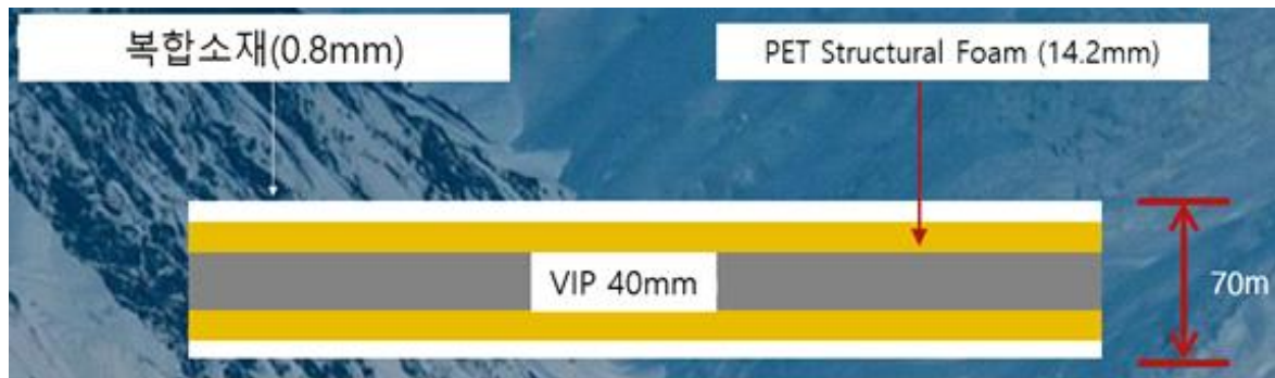
<그림 72. 진공단열재(VIP) 기반 복합단열재 모식도>
