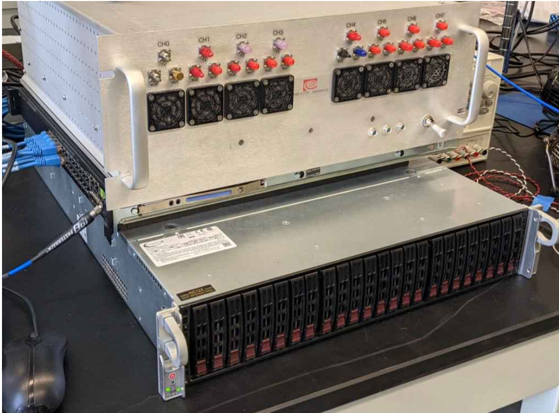
<그림 156. 표준랙에 설치된 디지털 서브시스템>
