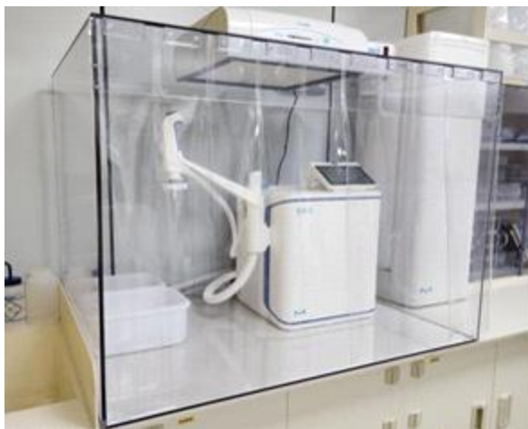
<그림 324. 초순수 제조시스템(좌) 설치 사진 및 클린부스 헤파필터 유닛(우)>
