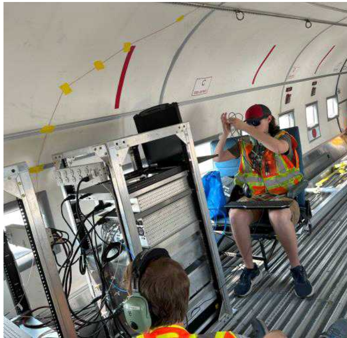
<그림 349, 바슬러BT-67 캐빈에 설치된 레이더 본체 시스템의 랙 설치 사진>
