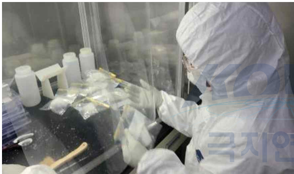
<그림 32. 남극내륙탐사 핸드오거 환경시료 전처리 및 CRDS 분석>
