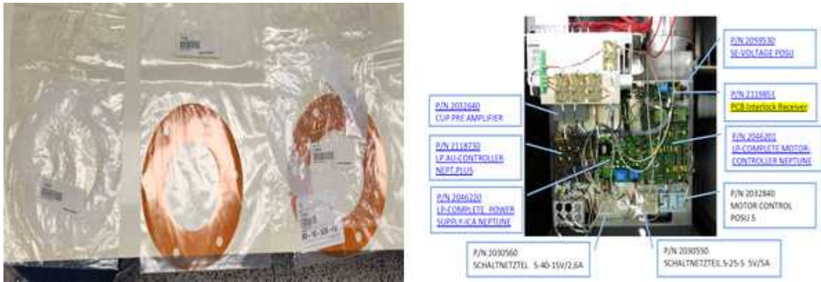
<그림 340. 교체 부품 - 캡톤호일(좌) 및 PCB 인터락리시버(우) >
