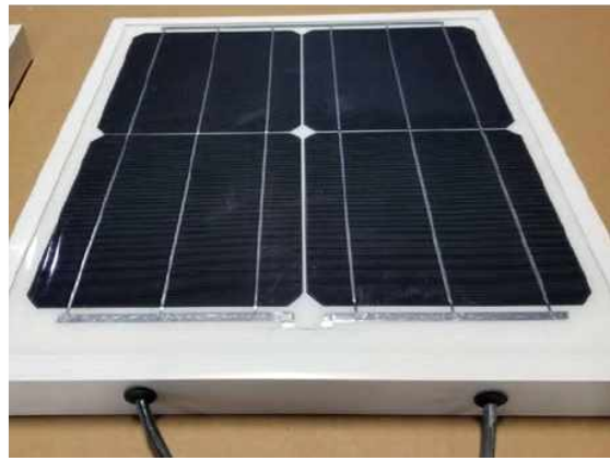
<그림 76. 에너지 하베스팅 컨테이너에 적용된 CIGS 방식의 플렉시블 태양광 패널>
