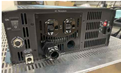
<그림 368. 팬 환기 장치가 추가된 3kW급 인버터>
