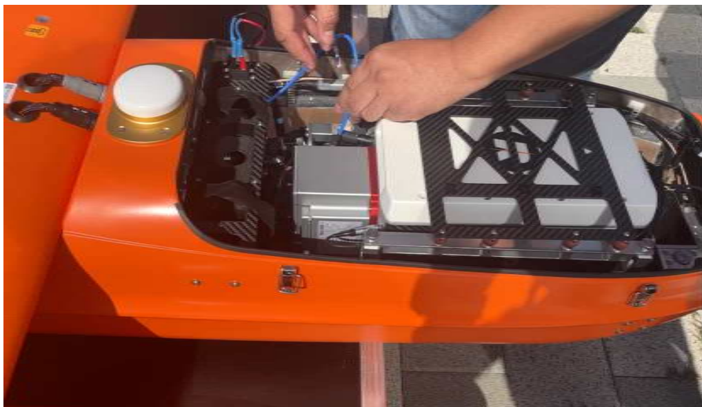
<그림 109. VTOL 완성기체에 장착중인 LiDAR>
