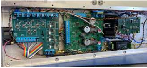
<그림 369. 기존 DC 제어회로(左) 및 개선된 DC 제어회로(右)>
