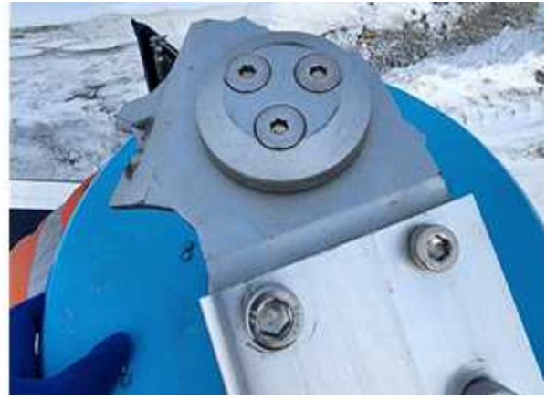
<그림 298. 중심축 전도로 인한 외부날개 및 고정 브라켓 파손>
