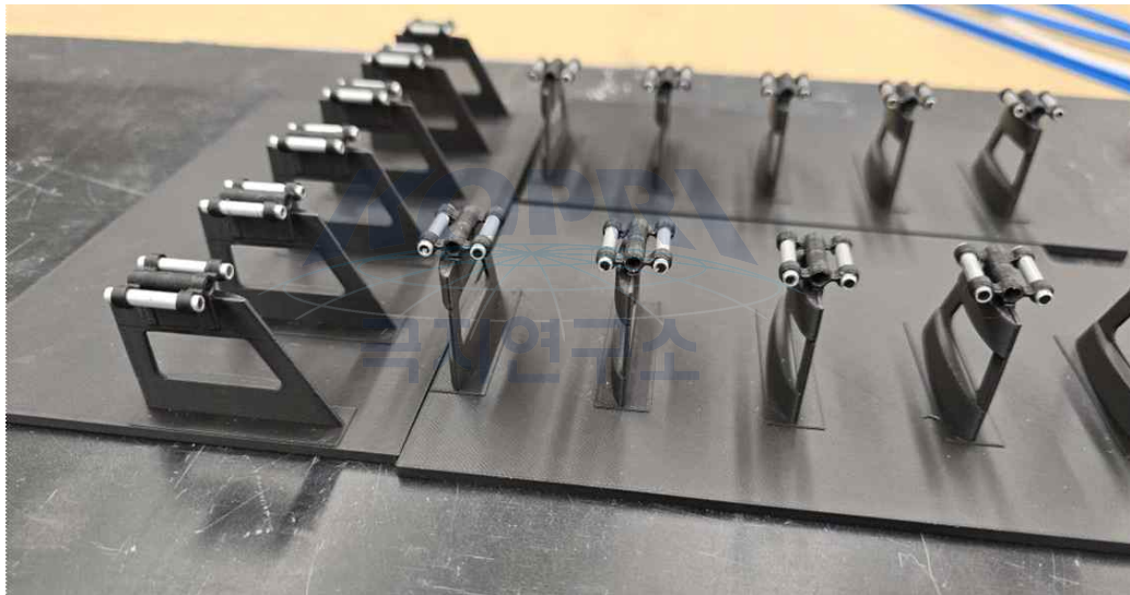
<그림 370. 1:8로 축소 제작한 안테나 어레이>
