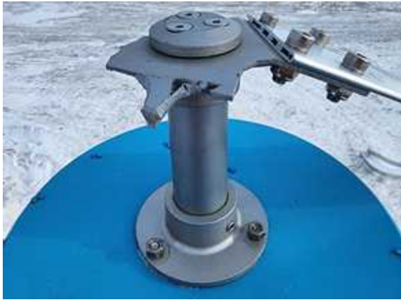
<그림 298. 중심축 전도로 인한 외부날개 및 고정 브라켓 파손>
