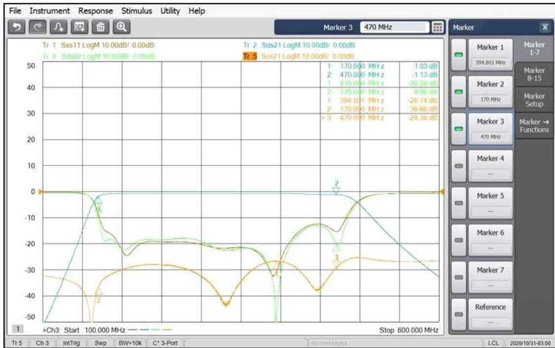
<그림 131. 고출력 발룬 시제품품 측정 결과>
