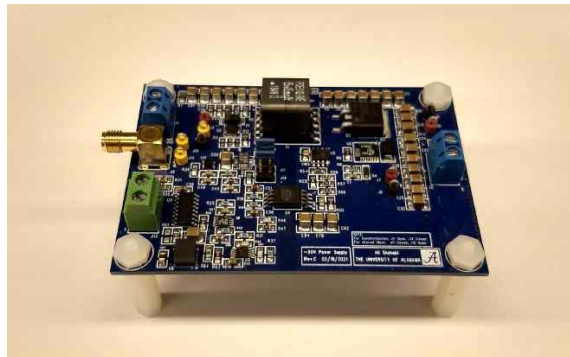
<그림 160. 고전력 송수신 스위치 서브시스템용 50V 전원 공급 장치>
