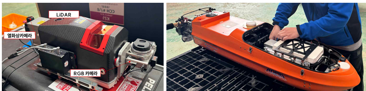
<그림 396. 센서 세부 구성 및 기체 장착>
