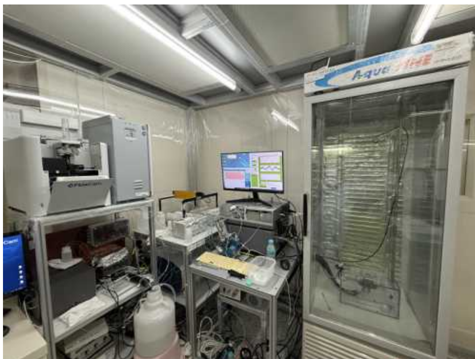
그림 3.1.50 빙하코어 연속흐름 분석법 입자형상분석기(Continuous Flow Analysis, CFA - FlowCam) 연속흐름 분석 시스템
