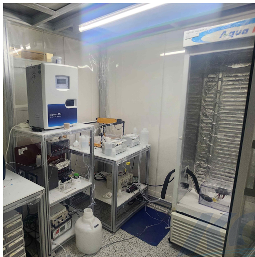
그림 3.1.47 빙하용융장치에 총유기탄소 검출기를 결합하여 청정실험실 클린부스에 설치한 모습(좌), 총유기탄소 검출기의 검량선(우)
