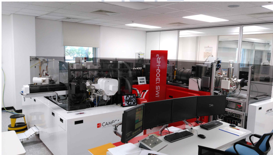
그림 73. 산소동위원소 조성 분석에 사용할 초고분해능 동위원소 현미경 시스템(IMS1300), 한국기초과학지원연구원 오창센터
