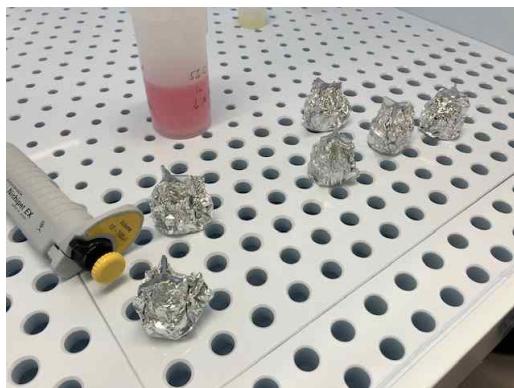
그림 62. 삼각형 모양의 바이알을 이용해 용액을 가열하고, Os는 팁 쪽으로, Re는 아래 남게 되는 distillation processes를 이용해 두 원소를 분리함
