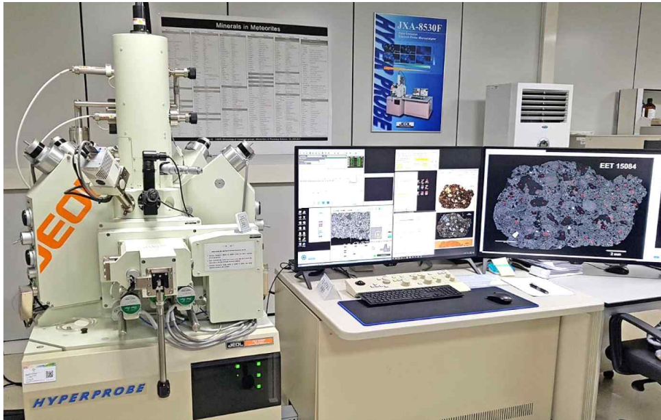
그림 51. 광물 화학조성 분석에 사용할 전자현미분석기(EPMA), 극지연구소
