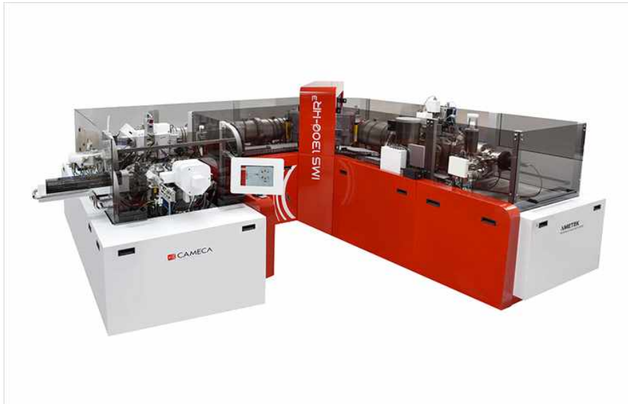
그림 66. 산소동위원소 조성 분석에 사용할 초고분해능 동위원소 현미경 시스템(IMS1300), 한국기초과학지원연구원 오창센터
