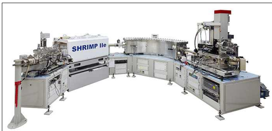
그림 46. U-Pb 연대측정에 사용할 고분해능 이차이온질량분석기(SHRIMP-IIe), 한국기초과학지원연구원 오창센터
