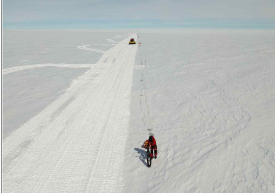
그림 140 탄성과 케이블 설치 모습 및 측선 전체 항공 사진
