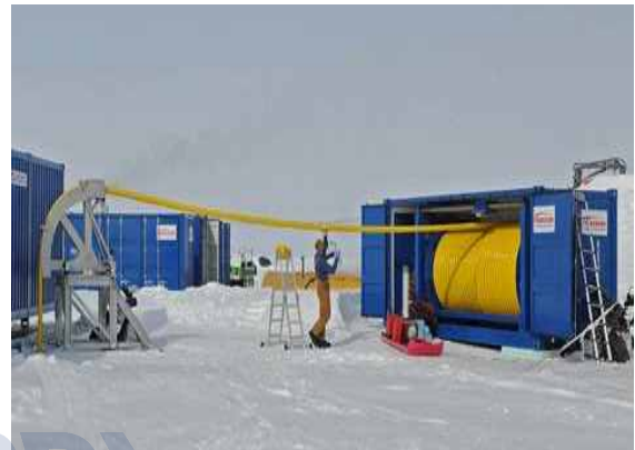
그림 253 호스릴 컨테이너 가동 시험 및 2,700m 시추호스 스풀링
