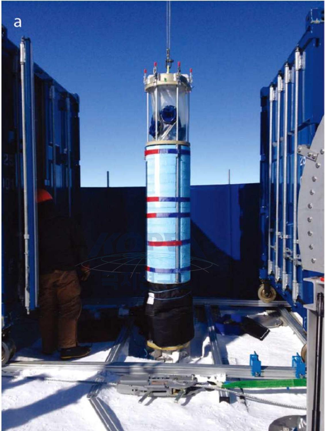
그림 161 Ellsworth 시추프로그램용 프로브의 현장 배치테스트 사진
