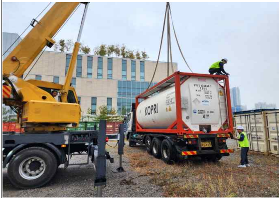
그림 227 항공유(JET A-1) 20,000L 충전 후 아라온 선적 완료한 ISO 20ft 탱크 컨테이너
