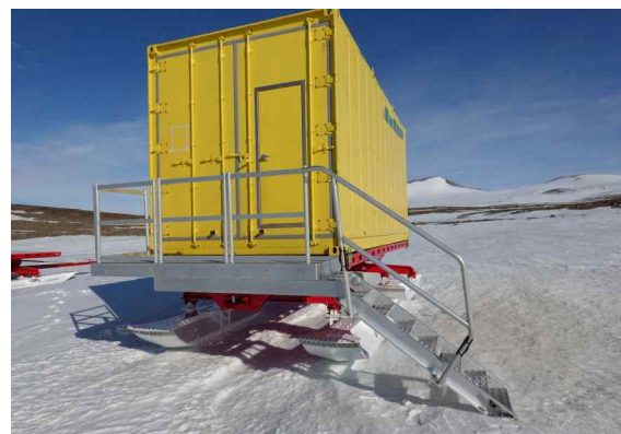
그림 264 이동식 청정실 내부 배치도 및 개발 완료된 이동식 청정실험실과 화물셀매 세트
