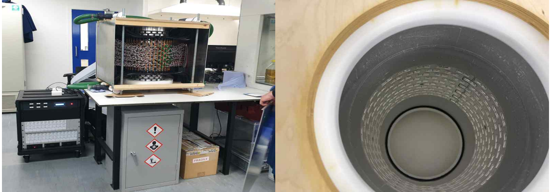
그림 213 제작된 Wellhead UV 유닛과 컨트롤 패널(좌), UV reactor 내부 사진(우)
