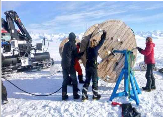
그림 253 호스릴 컨테이너 가동 시험 및 2,700m 시추호스 스풀링
