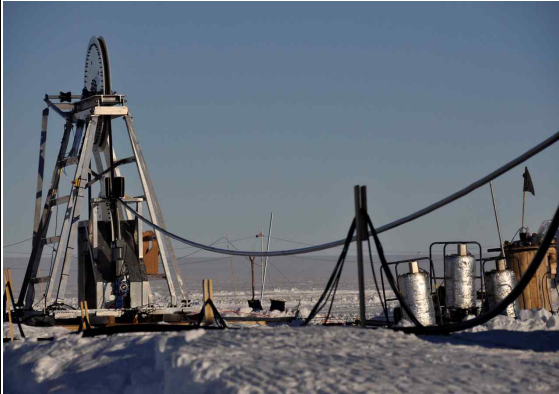
그림 185 심부빙저호 열수시추기의 시추호스 현장 활용 예
