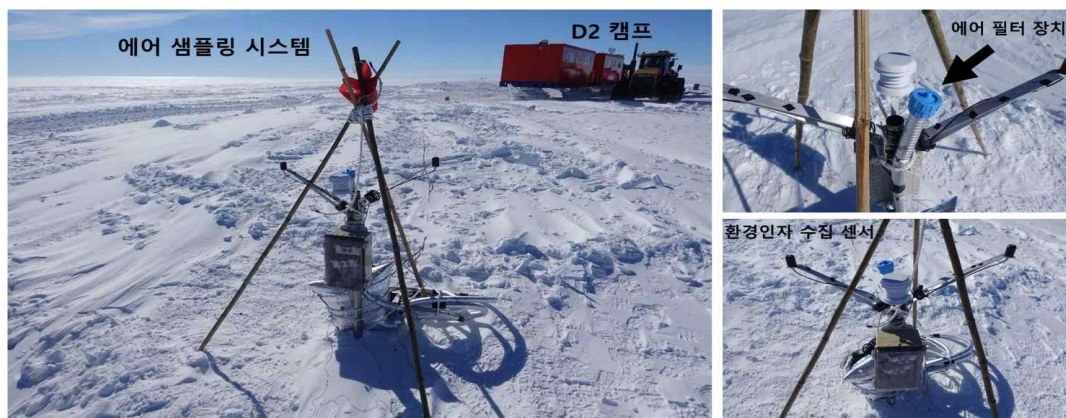
그림 105 대기시료 포집 장치 및 환경 데이터 수집 센서
