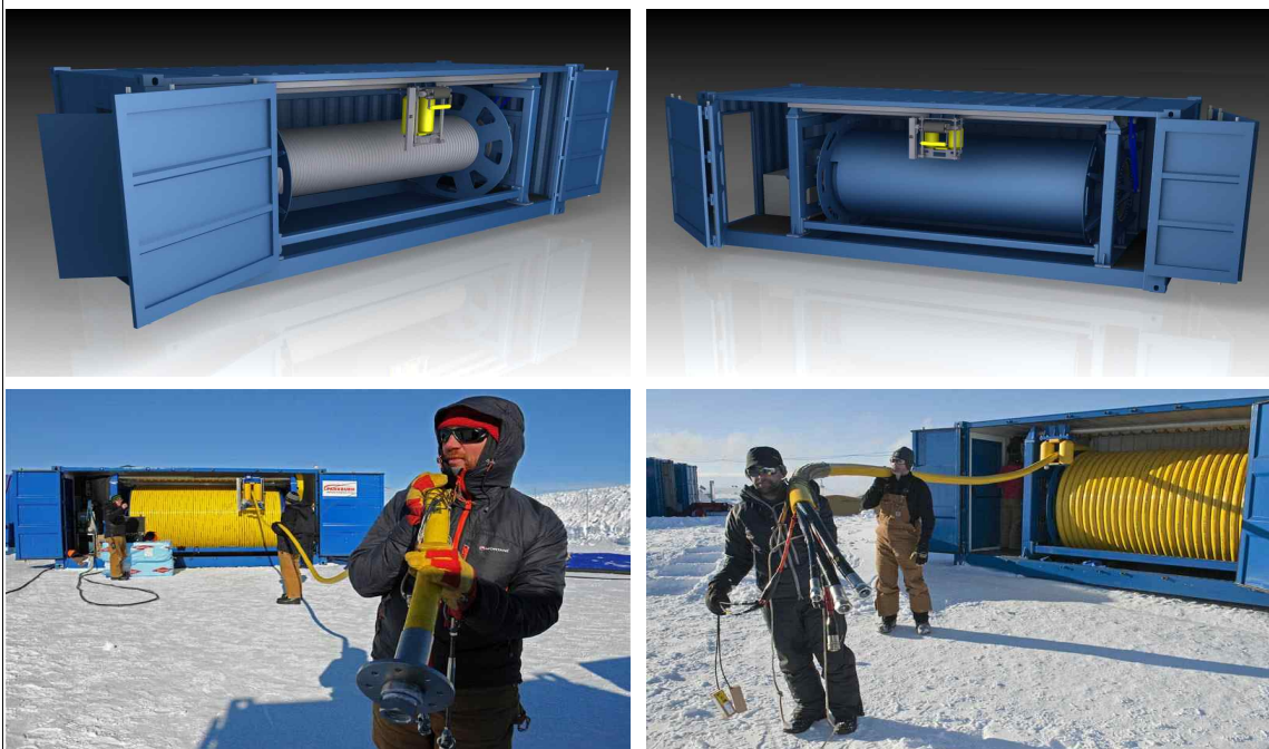
그림 163 영국 BAS Ellsworth호 시추시스템의 드릴 호스 및 윈치 컨테이너 모듈
