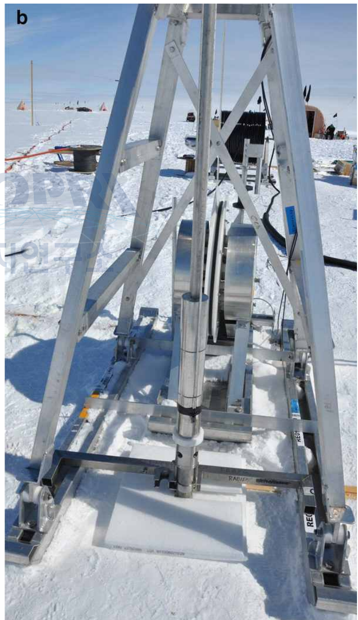
그림 156 BEAMISH 시추프로그램에 사용된 타격식 퇴적물 시추기
