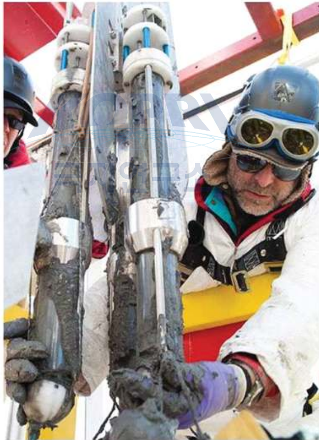
그림 88 Whillans호 퇴적물 시추에 활용된 UWITEC 다중시추기
