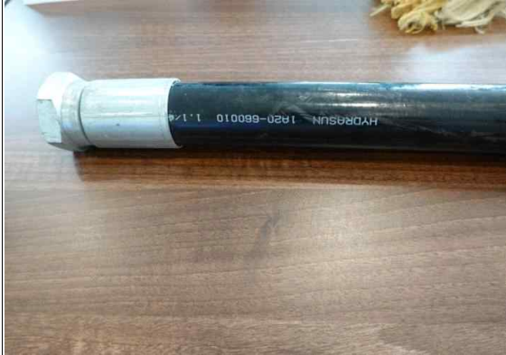
그림 186 시추호스의 외형 및 단면 사진
