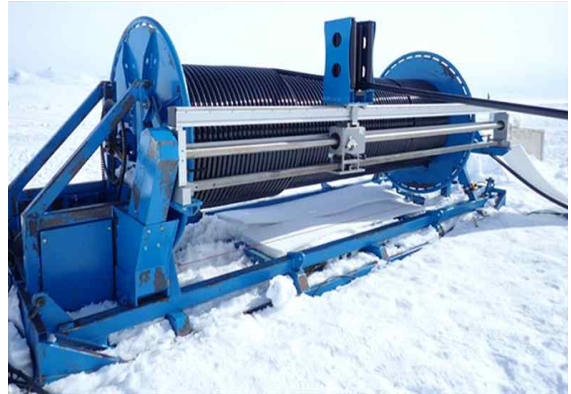
그림 185 심부빙저호 열수시추기의 시추호스 현장 활용 예
