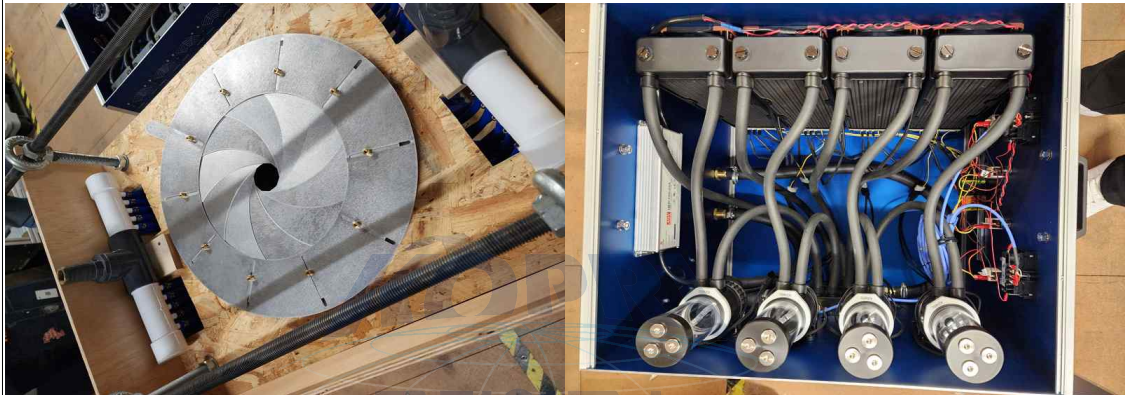
그림 214 BAS Wellhead UV unit 용 하우징 및 냉각장치 프로토타입
