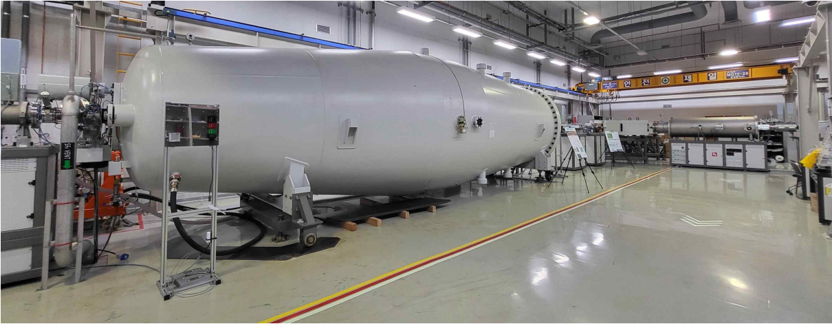
그림 6. KIST의 6MV Tandetron AMS. ^{10}\text{Be}/^9\text{Be} 를 분석하기 위해 4.5MV까지 가속하여 \text{Be}^{2+} 로 뽑아낼 수 있기 때문에 \text{Si}_3\text{N}_4 foil을 이용해 가장 큰 동중원소 오염원인 B를 제거해 줄 수 있다.
