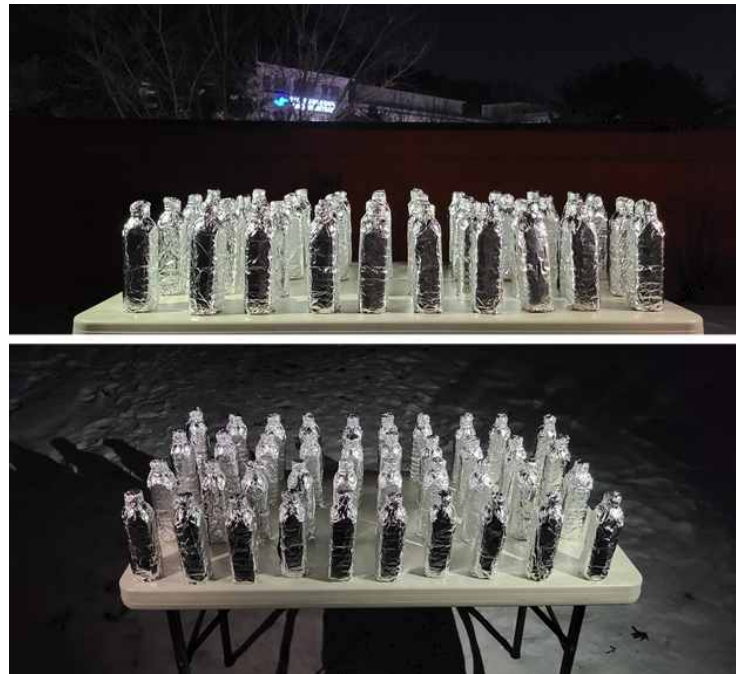
그림 33. 동결/염소이온/peroxymonosulfate 시스템의 야외 실험 사진
