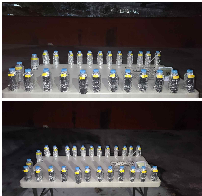
그림 77. 자연 동결을 이용한 브롬산염 제거 야외실험
