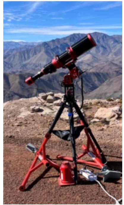
[한국천문연구원 대전본원 및 칠레 세로 토를로에서의 천문시상 망원경 시제품 시험관측]
