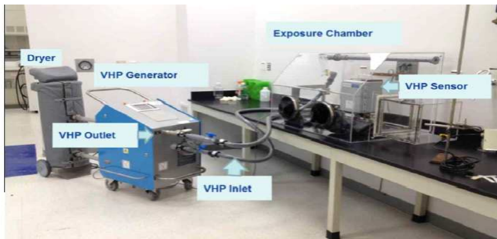
그림 31. NASA Europa 탐사를 위해 Vapor hydrogen peroxide (VHP) generator와 chamber를 활용한 미생물 오염 방지 전략 (출처: Aaron, Kim M., et al. "Planetary protection for Europa radar sounder antenna." Advances in Space Research 57.9 (2016): 2013-2021)
