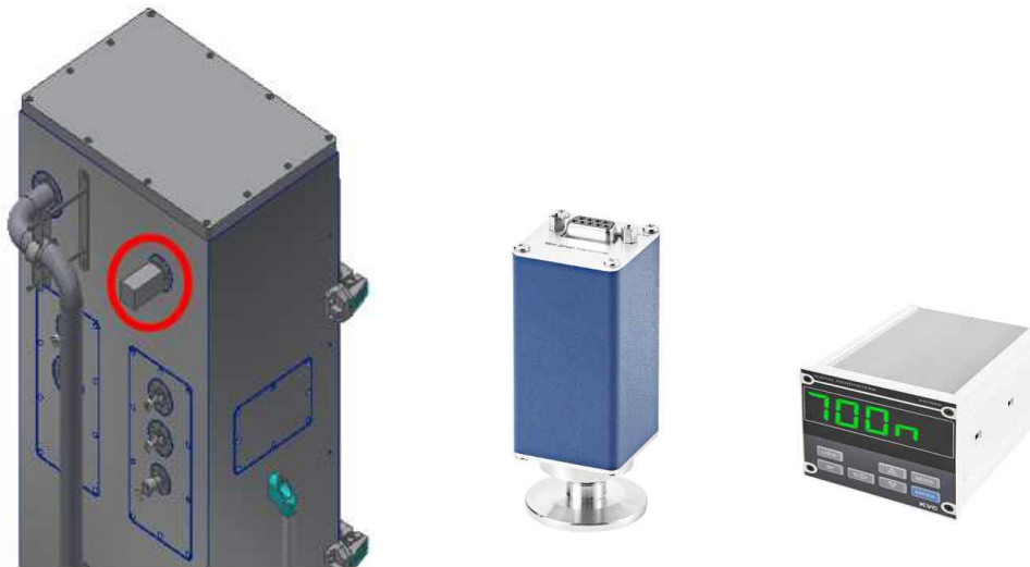
그림 17. 디지털 게이지 설치 위치 및 디지털 진공 게이지와 화면 표시부
