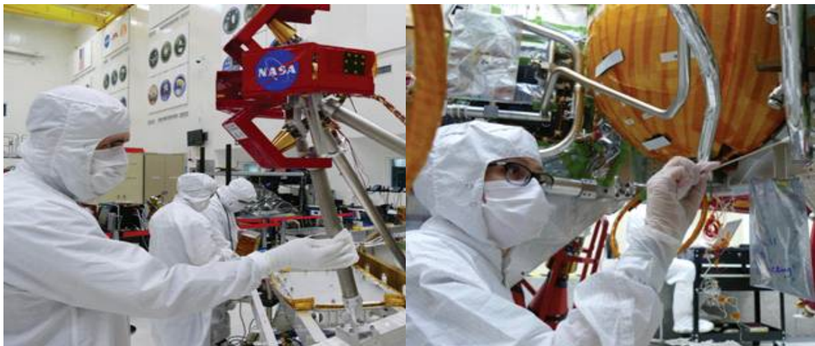
그림 27. 멸균 천과 과산화수소를 이용한 탐사 장비표면 소독. 출처: www.nasa.gov
