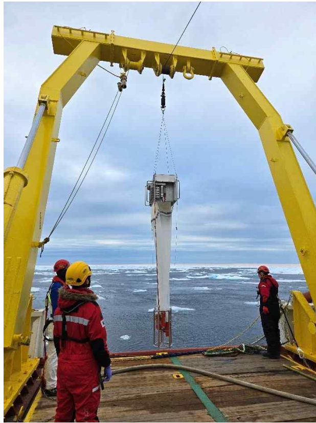
그림 8. 북극해 동물플랑크톤 수심별 채집을 위한 멀티넷 수행 사진.
