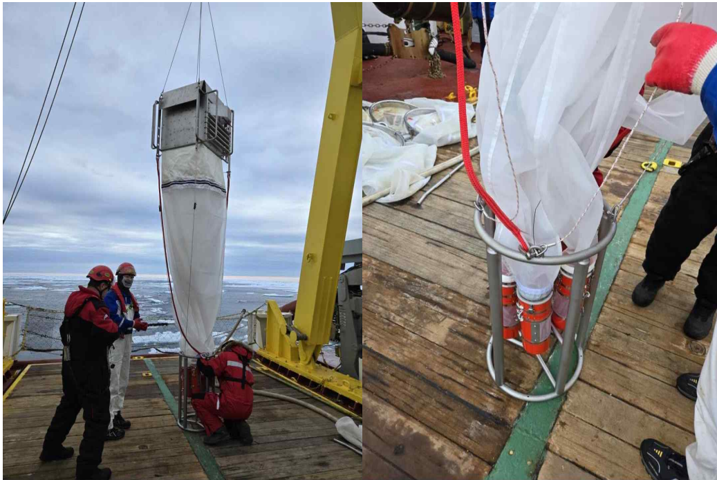
그림 2. 멀티넷 현장사진(좌), 수집채집을 위해 세팅한 하드버킷 5개와 프레임(우).
