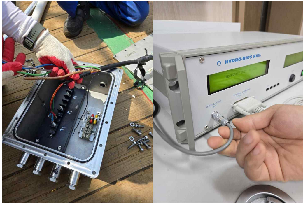
그림 4. 아라온 데이터 케이블과 연결하는 허브(좌)와 데이터 케이블과 연결되어 있는 멀티넷 실시간 조종 장치(우).
