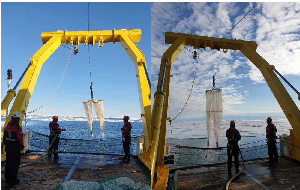
그림 7. 북극해 동물플랑크톤 채집을 위한 150 \mu m 네트(좌), 와 330 \mu m 봉고네트(우) 수행 사진.
