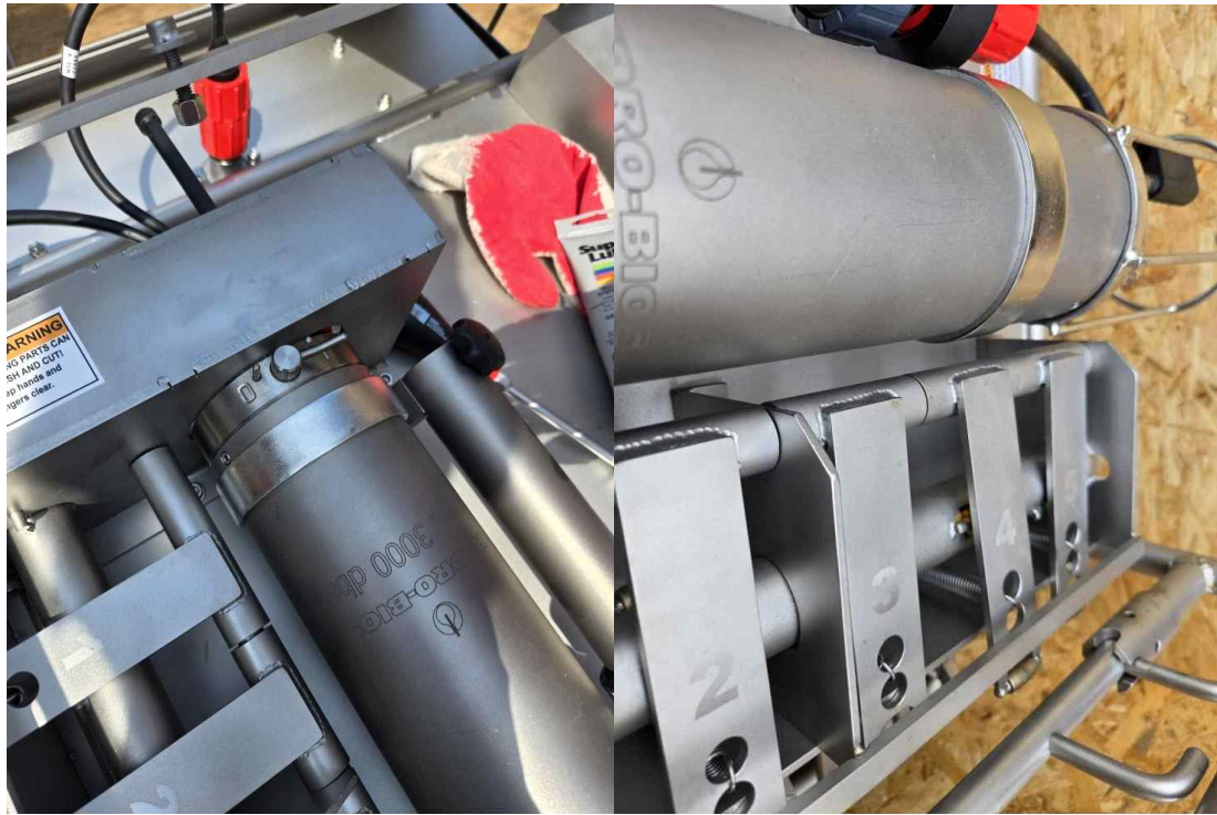
그림 3. 수압 3000m 까지 견디는 압력계(좌)와 수온, 염분 등 센서 장착 모습(우).
