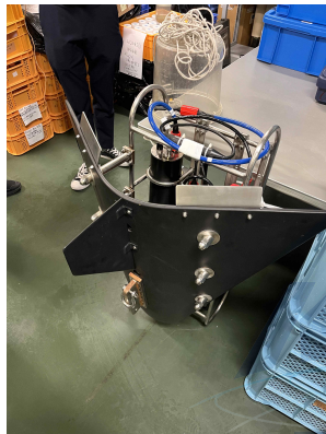
[그림 11] CPICS (Continuous Particle Imaging and Classification System)의 수직 및 수평 인양을 위해 제작된 프레임
