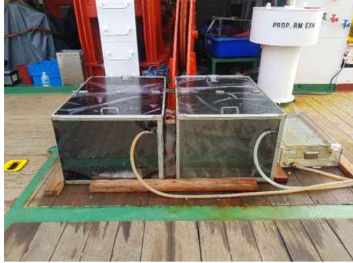
[그림 12] 태평양 북극해에서 동물플랑크톤의 섭식 효과를 정량적으로 평가하기 위하여 수행한 배양 실험. 왼쪽 사진은 실험을 위해 아라온 호 데크에 설치한 해수 순환 배양기. 오른쪽 사진은 현장에서 실험에 사용된 Calanus glacialis 의 배양 사진.
