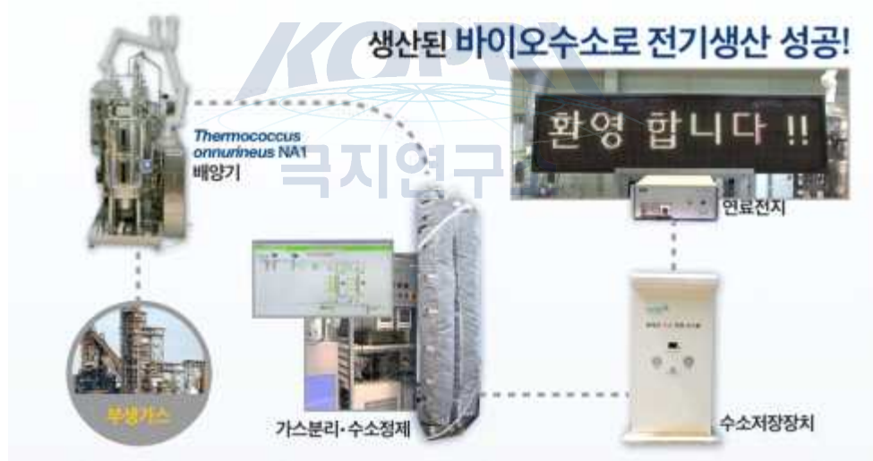
그림 2-27. 초고온 고세균을 이용한 바이오수소생산 기술개발
