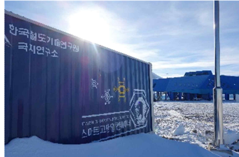
<VIP 단열구조의 스마트 고단열 컨테이너와 장보고기지 성능테스트 장면>
