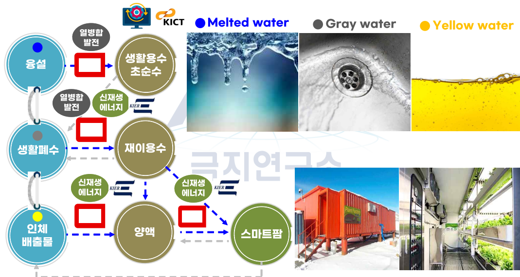
<남극 내륙기지 건설을 위한 저에너지 물 생산 및 재이용 시스템 개념도>
