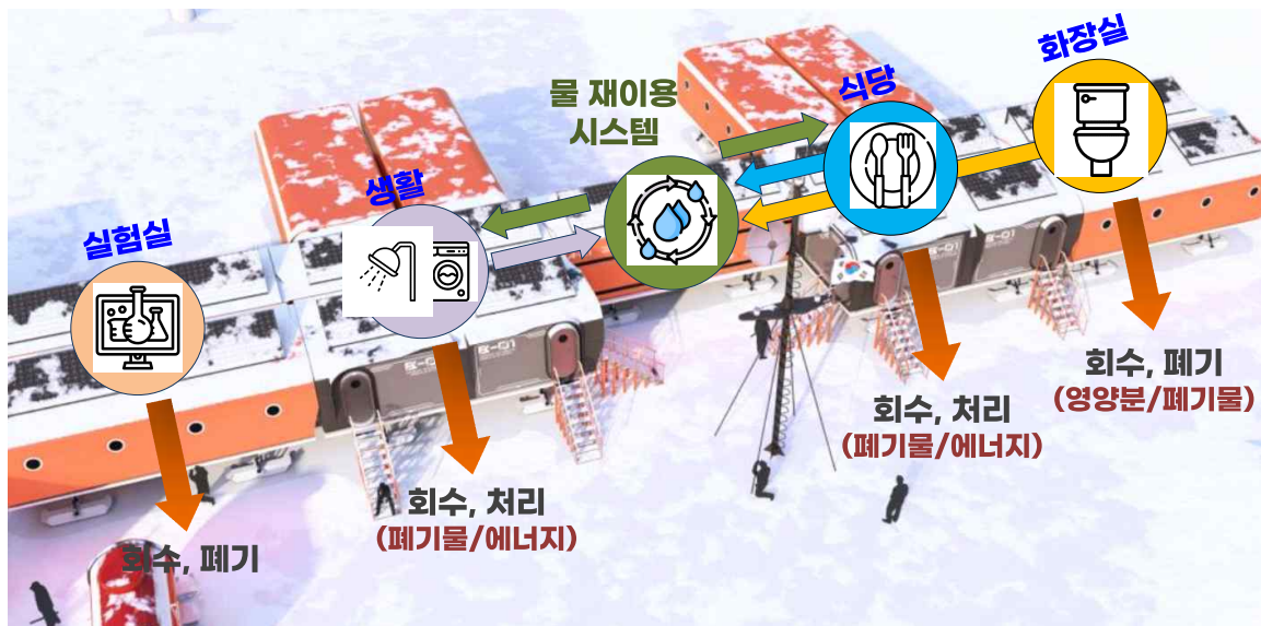
<남극 내륙기지 수원 활용 및 재이용 처리 구조 (예시)>
