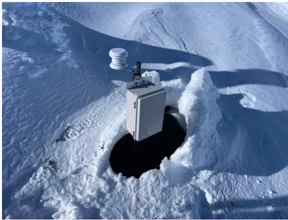
[그림 7. 지중 온습도 로거 준비 장면(위), 멜버른 화산 Cryptogam Ridge 부근 로거 설치 장면(아래). 능선 가운데 ice hummock 지역의 지열 온도가 40-05도로 높으나 금지구역(prohibited zone)으로 지정되어 부득이하게 온도가 다소 낮은 경계면 사이트에서 측정]
