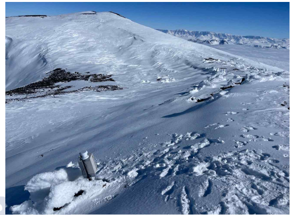
[그림 7. 지중 온습도 로거 준비 장면(위), 멜버른 화산 Cryptogam Ridge 부근 로거 설치 장면(아래). 능선 가운데 ice hummock 지역의 지열 온도가 40-05도로 높으나 금지구역(prohibited zone)으로 지정되어 부득이하게 온도가 다소 낮은 경계면 사이트에서 측정]
