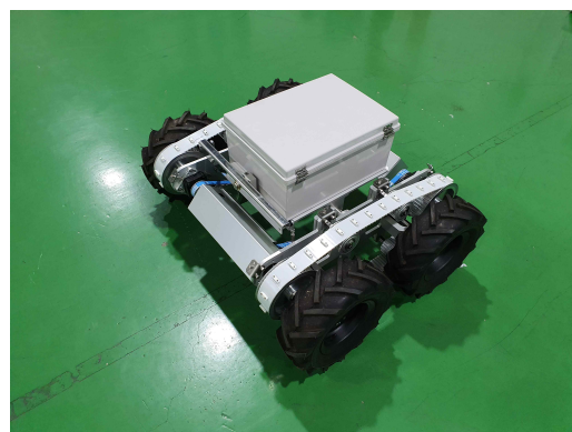
그림 7 휠-트랙 구동 아이디어 검증을 위한 구동 모듈 샘플
