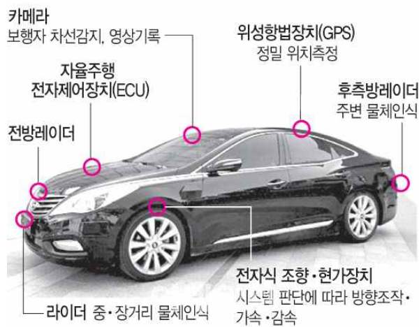
그림 1 상용차량의 자율주행을 위한 주요 구성
