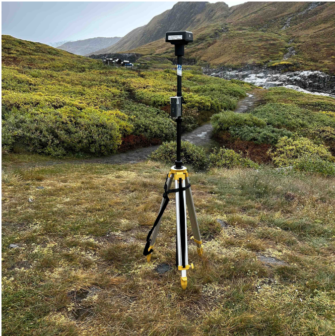
<DRTK-2 GNSS 수신기 현장 설치 모습>
