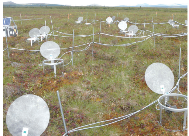
(그림1) 알래스카 카운실 지역에 극지연구소가 설치한 챔버 시스템 전경. 챔버 시스템은 지중에서 올라오는 이산화탄소 양을 포집하여 동토층에 살고 있는 툰드라 식생의 변화와 미생물 변화에 따라 달라지는 이산화탄소 양을 측정해 주는 시스템이다.
