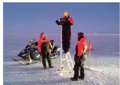
극야 기간 해빙 두께 측정 모습. 해빙이 두꺼워 사다리를 이용해야 했다.
