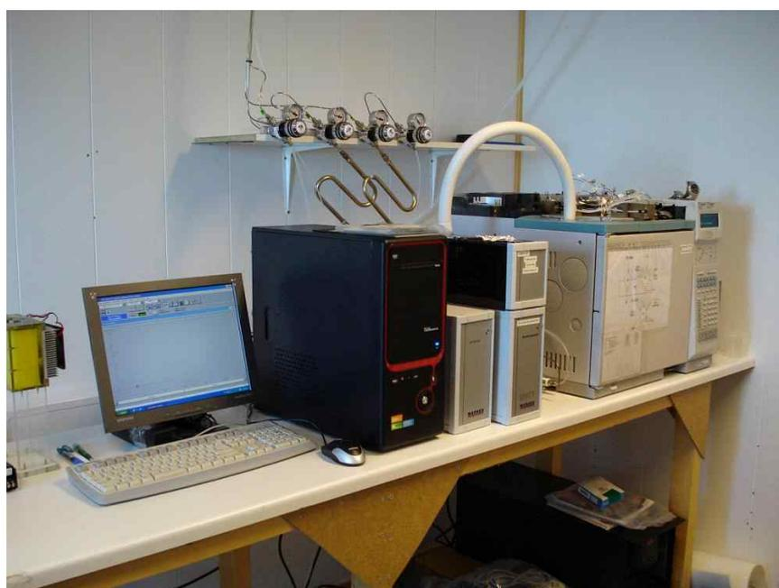
24일 간의 다산 기지 방문 기간 중 처음 1주일 동안 기기 운반 및 가스 라인 연결, leak test, 개별 기기 점검 등에 할애하였으며 다음 1주일 동안 기기 운영 조건 최적화, 그리고 나머지 기간은 연속 모니터링 시범 실시 및 문제점을 보완하는데 초점을 맞추었다. 기기 운영은 2007년 8월 15일에 최초로 시작하였으며 현재 하루 24시간 중에 4시간은 blank 및 표준 가스 측정을 통한 기기 보정에 할애되어 있고, 나머지 20시간 동안 한 시간 간격으로 대기 시료를 측정하고 있다. 그리고 정기적인 기기 점검은 노르웨이 기지의 엔지니어들의 도움을 받아 실시하고 있다.
