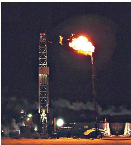
❶ 그림5 2002년 캐나다 북극 영구동토지역인 말릭(Mallik) 시추공에서 가스하이드레이트를 시험생산 하는 장면(출처: Max et al., 2006).
