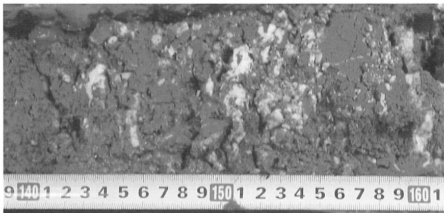
図 2 Hieroglyph ストラクチャーで採取されたメタンハイドレート含有コア (LV32-13GC)。
