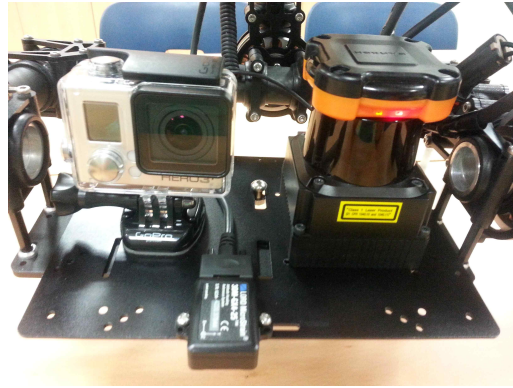
그림 3.3.6b 레이저 스캐너(오른쪽), 관성항법장치(중앙 아래) 및 카메라(왼쪽)
