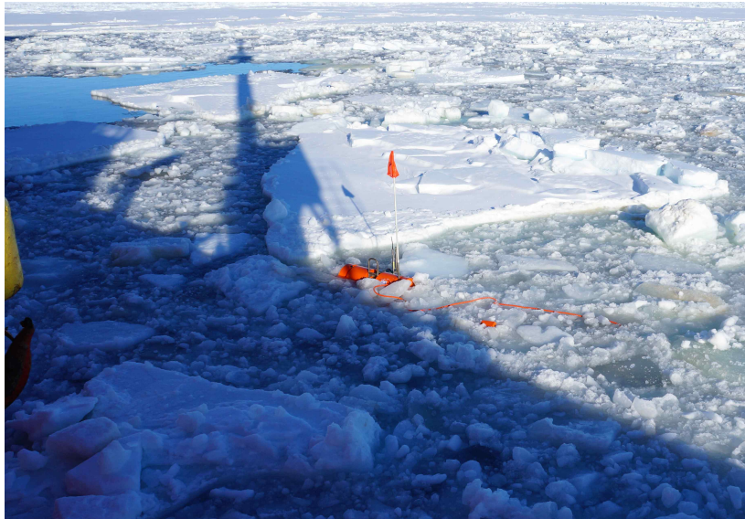
그림 3.4.5 2014년 12월 14일 현지시각 21시에 음파원격 이탈 신호를 받고 해수면에 떠오른 KPOBS01
