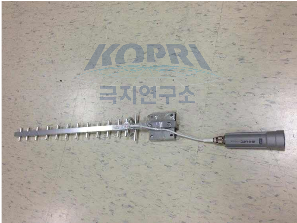
그림 3.1.8 Yagi 안테나 부분: N-type 커넥터로 Bullet 장비와 직접 연결 가능
