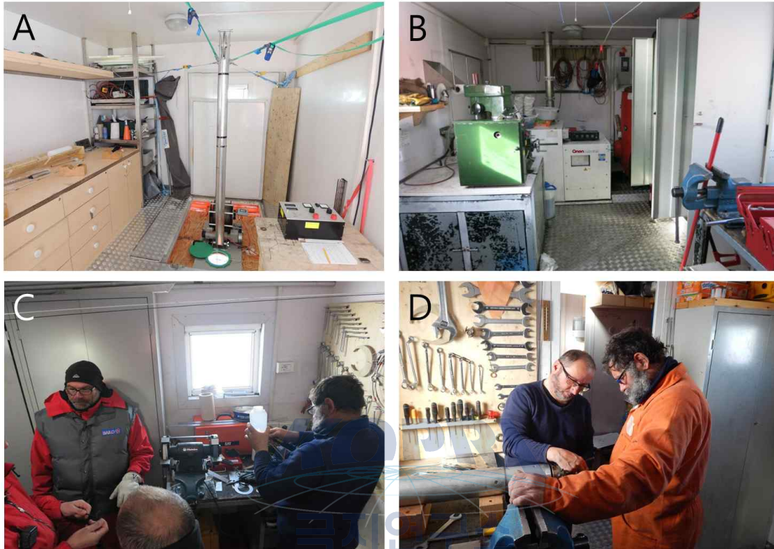
그림 33 (A) 드릴 매거진 내부 (내부에는 천부빙하시추기를 설치하여 이동하며 빙하시추를 할 수 있음). (B) 카라반 작업실 및 발전기 (보일러)실. (C) 카라반 내의 작업실 (각종 공구들이 갖추어져 있어서 대부분의 작업과 수리를 할 수 있음). (D) 작업실에서 시추기를 수리하는 시추작업자와 기술자.
