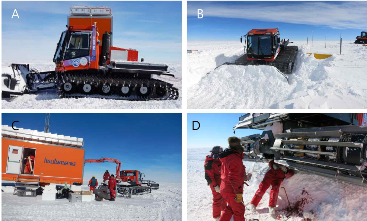
그림 26 (A) 피스텐 불리 (PB330 D), 앞쪽에 스크린 블레이드가 장착되어있음. (B) 피스텐불리를 이용해 쌓인 눈을 치우거나 작업 공간을 만듦. (C) 피스텐불리 뒤쪽에 장착된 크레인을 이용해 중량 화물을 하역하는 모습. (D) 피스텐불리 점검 (윤활유 교체 및 트랜스미션 교체)
