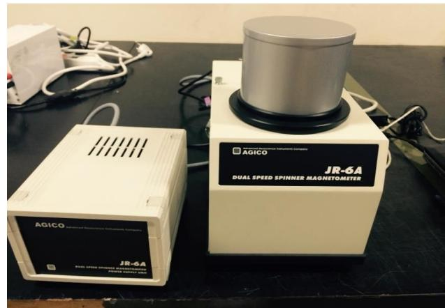
그림 46. Spinner magnetometer
