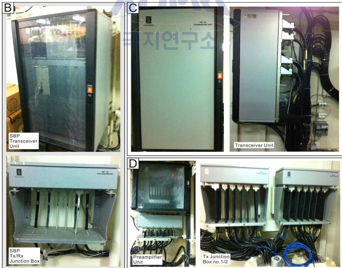
그림 8 아라온호에 설치된 EM-122 시스템
