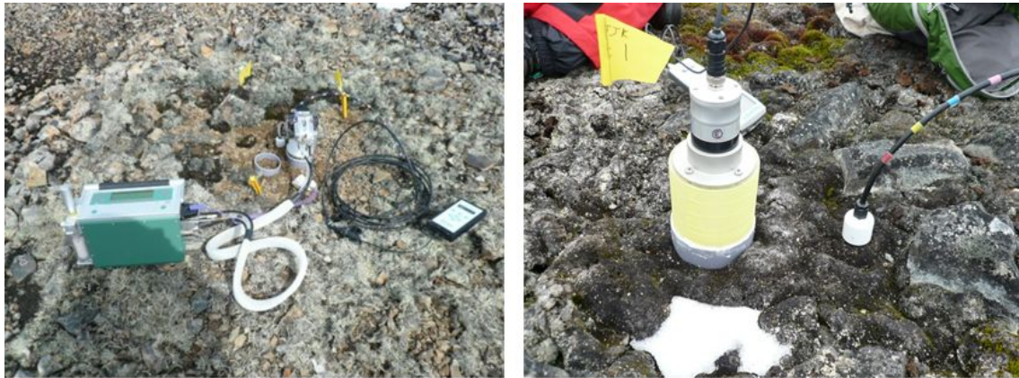
그림 33. 토양 이산화탄소 플럭스 측정을 위한 챔버 시스템 사진, Closed dynamic chamber (왼쪽), Closed chamber(오른쪽)
