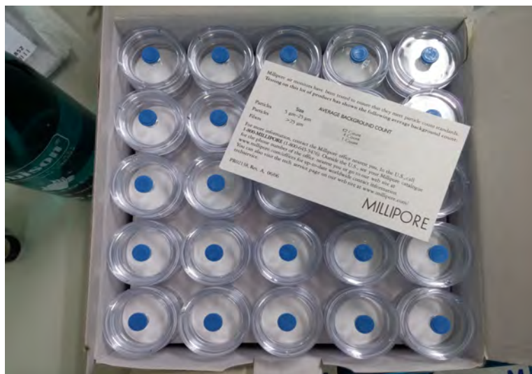
그림 12. 참고지역 시료 채집에 사용되는 Merck사의 필터 및 필터홀더
