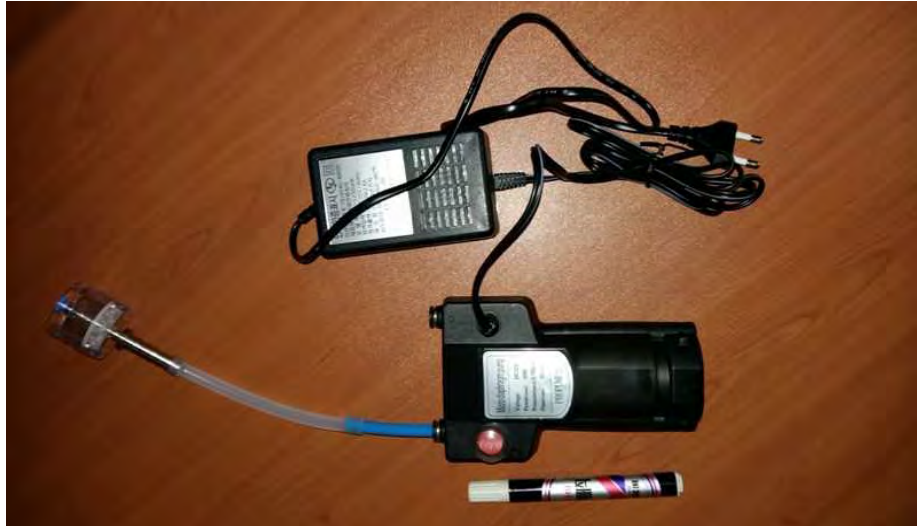
그림 4. 인천 및 제주도 지역의 연속적인 시료채취에 사용되는 키트와 Merck사 orifice
