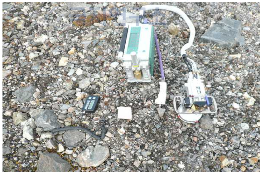
그림 2-3. 토양 이산화탄소 플럭스 측정에 사용된 휴대용 챔버 시스템
