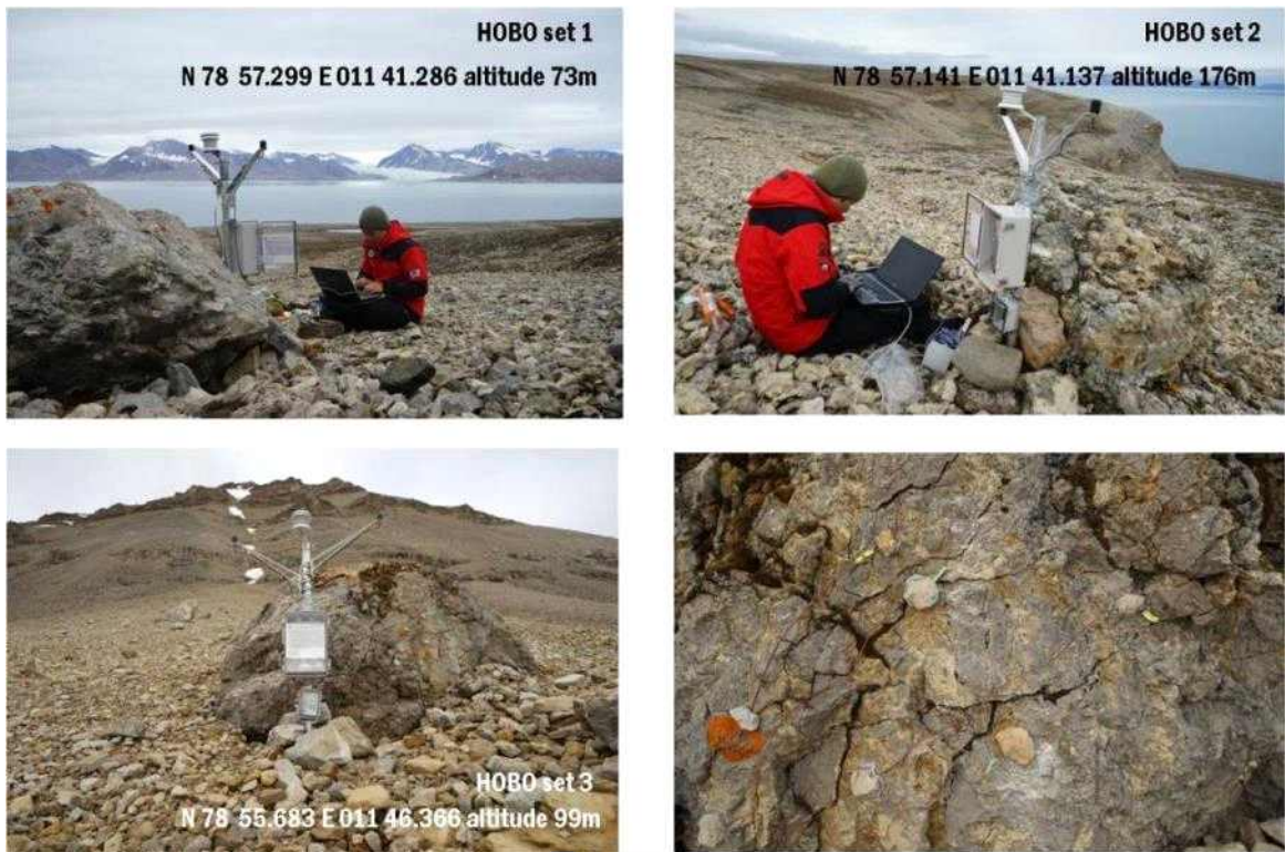
그림 1-54. (a) HOBO logger set (b) HOBO logger 설치 지역 (c) 설치된 HOBO 장비
