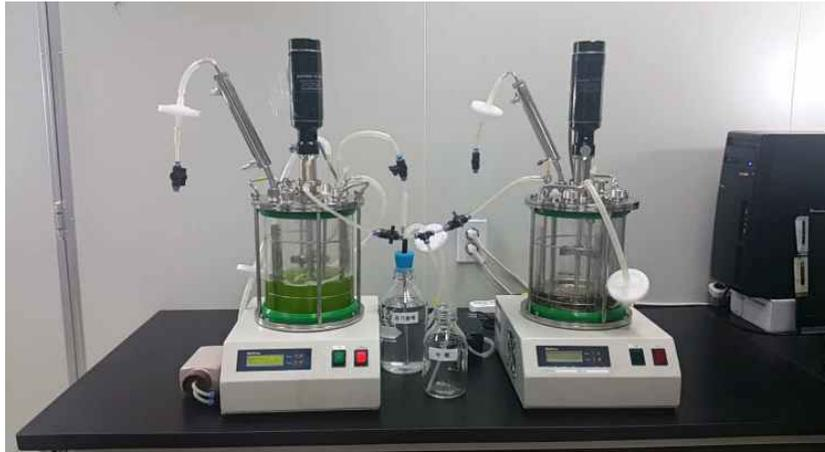
그림 46. 자동화 순환배양 및 수확 시스템.
