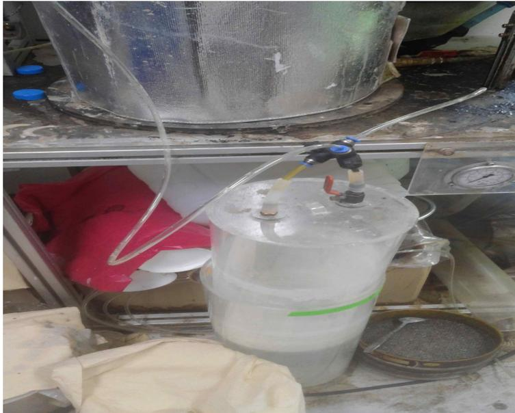
그림 54. Biogas 수중포집.
