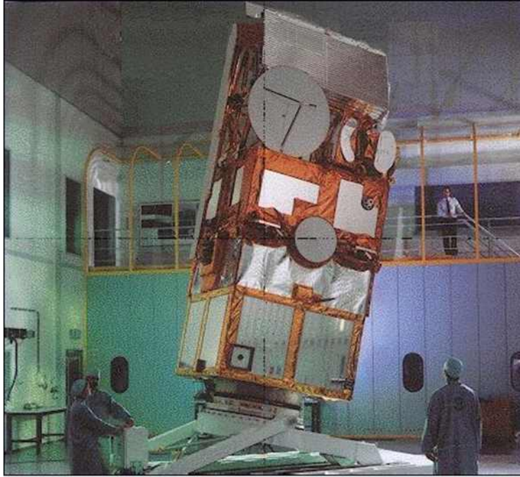
그림 9. ERS-1 조립 장면 (출처: ESA)
